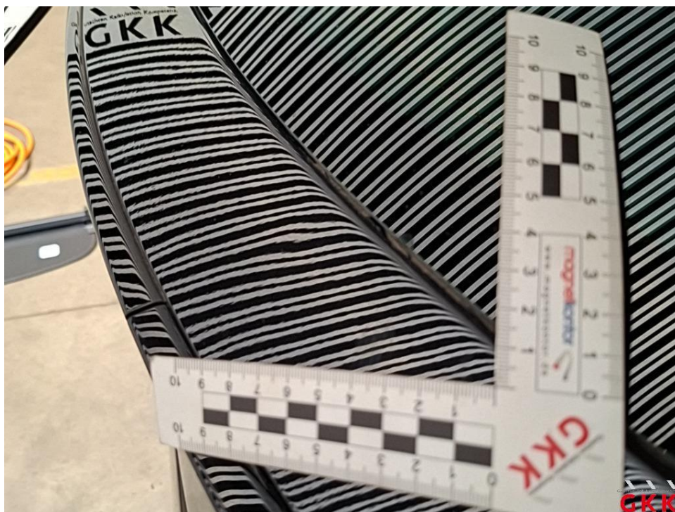
Bild 22 Heckklappe, beschädigt, kalt drücken
