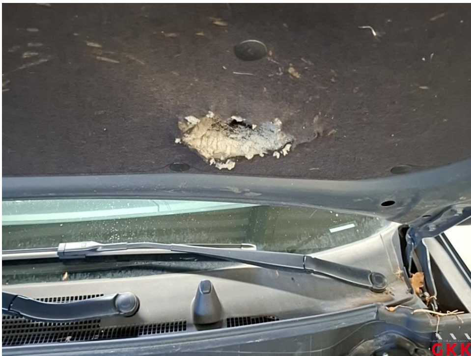
Bild 16 Motorhaube, Dämmmatte, beschädigt, ersetzen
