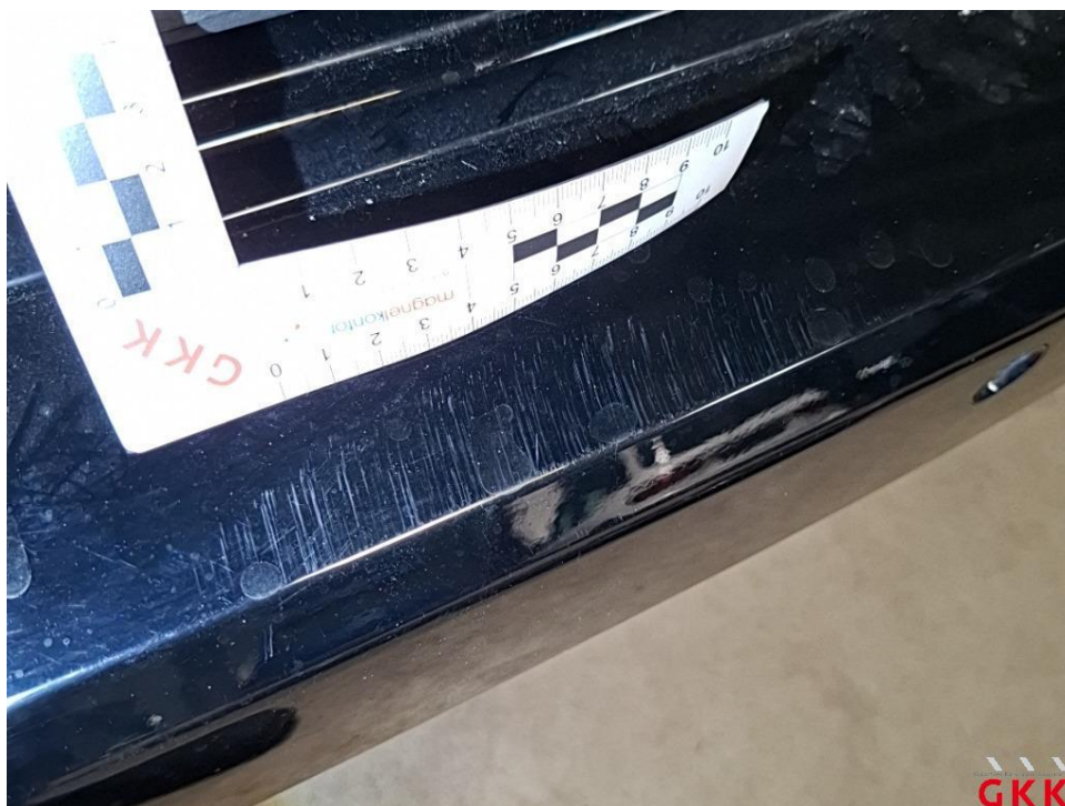
Bild 25 Stoßfänger hinten, Verkleidung -lackiert-, verkratzt, lackieren
