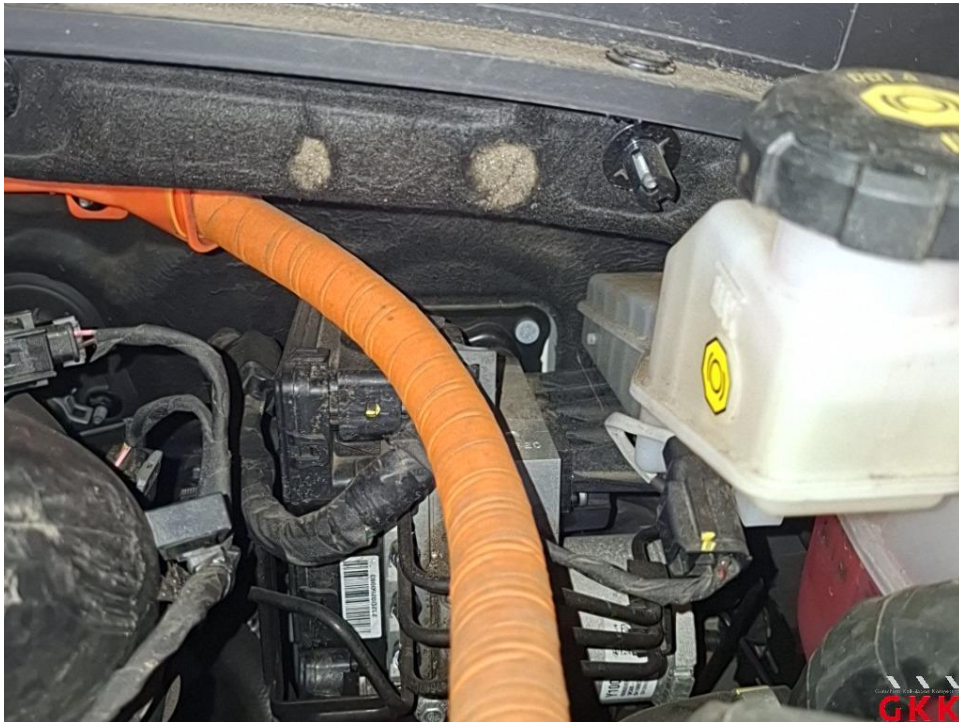
Bild 27 Motorraum, Dämmmatte, beschädigt, ersetzen
