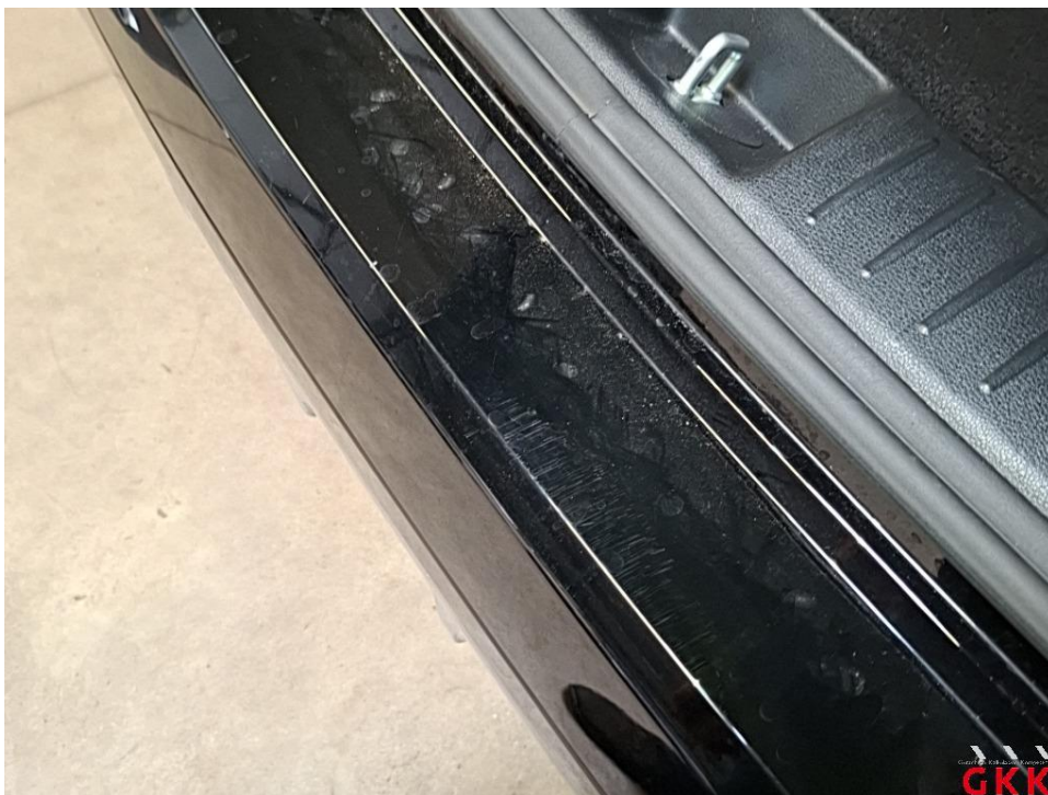
Bild 24 Stoßfänger hinten, Verkleidung -lackiert-, verkratzt, lackieren
