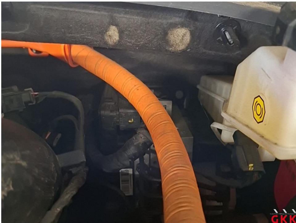
Bild 28 Motorraum, Dämmmatte, beschädigt, ersetzen
