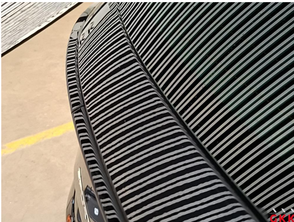
Bild 23 Heckklappe, beschädigt, kalt drücken
