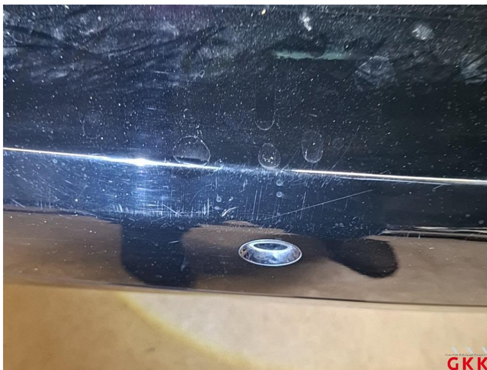
Bild 26 Stoßfänger hinten, Verkleidung -lackiert-, verkratzt, lackieren
