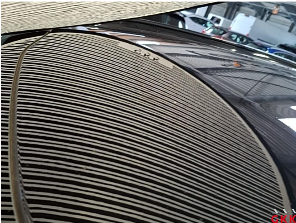
Bild 20 Dach, beschädigt, kalt drücken
