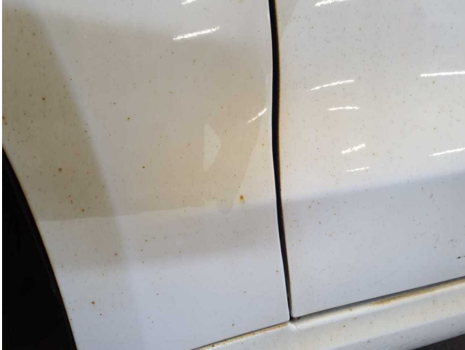
Damage 5: Body: Body (Flugrost - Mehrkosten können entstehen) - Soiled - Clean
