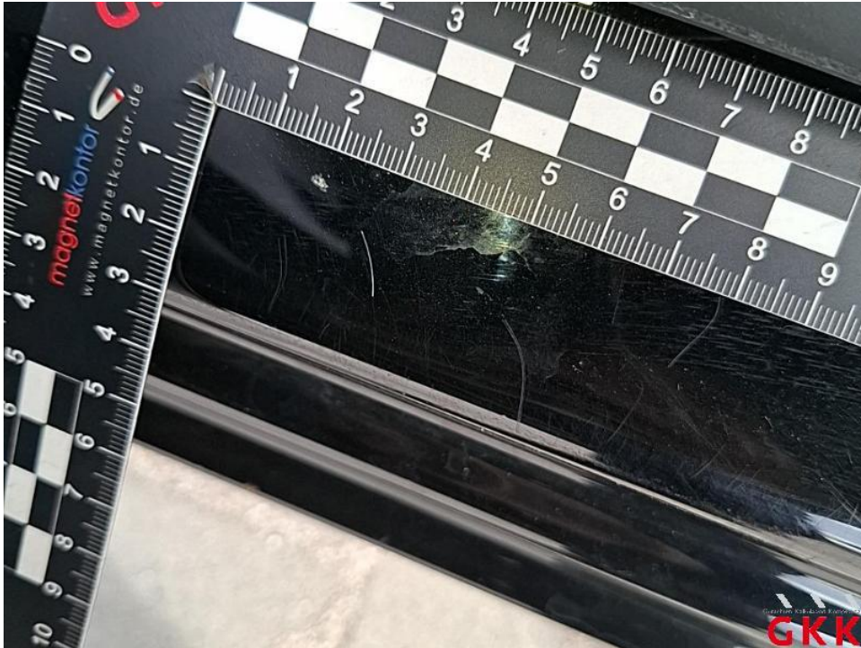
Bild 61. Tür vorne links, Einstieg, verkratzt, lackieren
