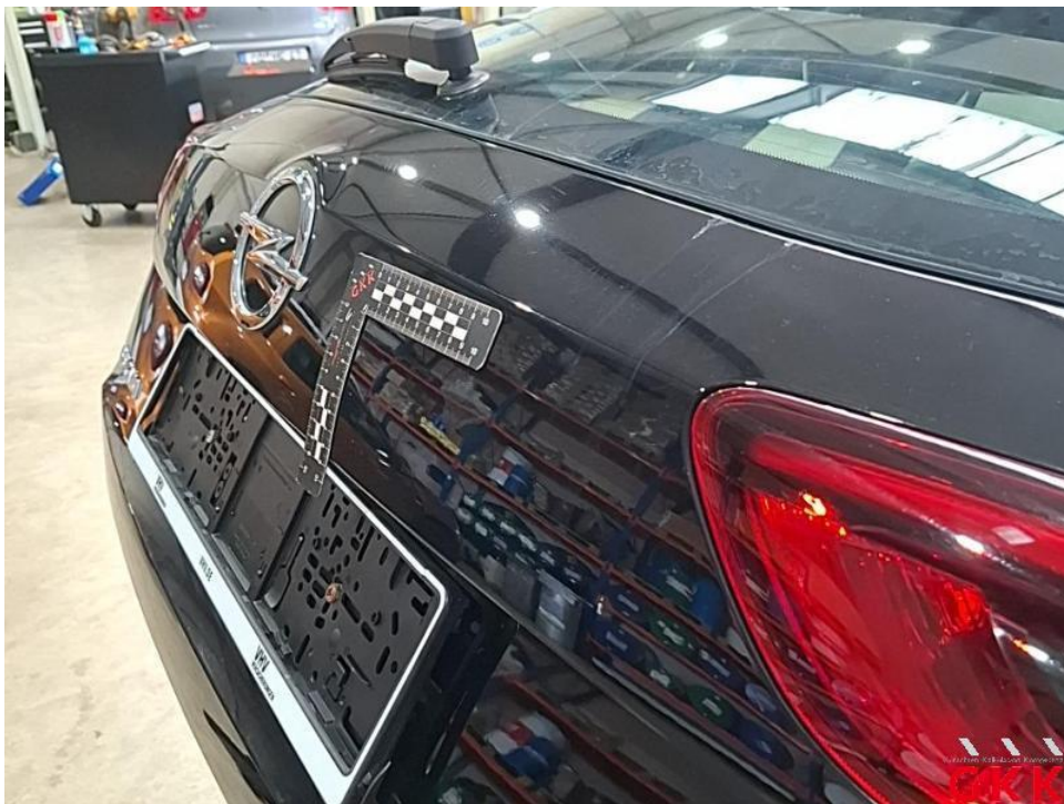
Bild 34. Heckklappe, beschädigt, instand setzen - lackieren
