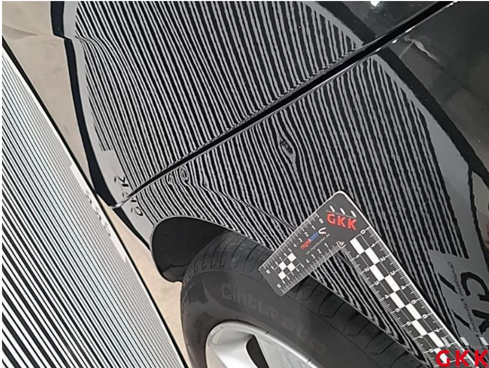
Bild 31. Seitenwand links, beschädigt, instand setzen - lackieren
