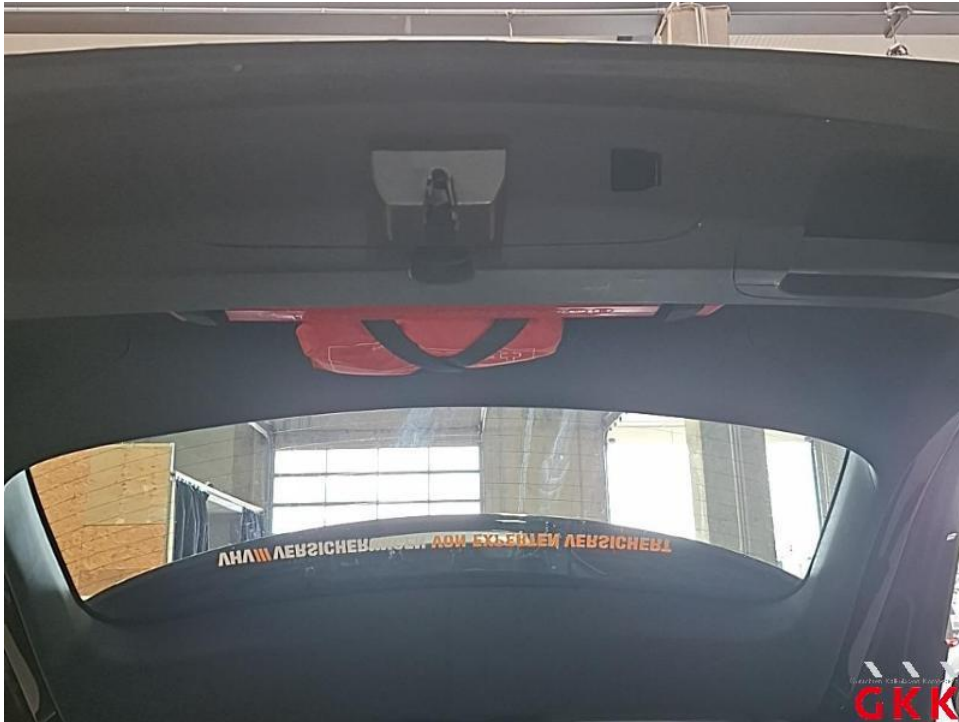
Bild 37. Heckklappe, Innenverkleidung, beschädigt, ersetzen
