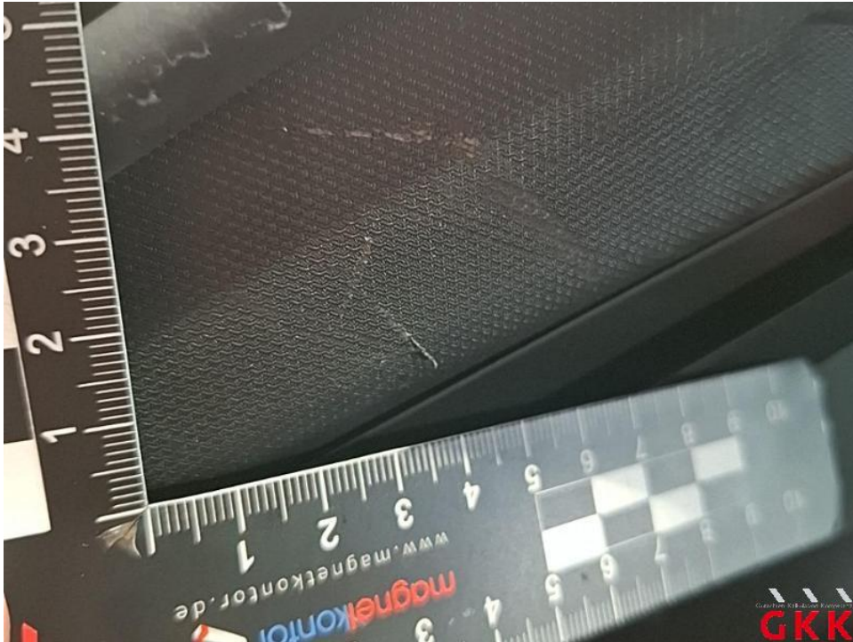
Bild 43. D- Säule links, Innenverkleidung, verkratzt, ersetzen
