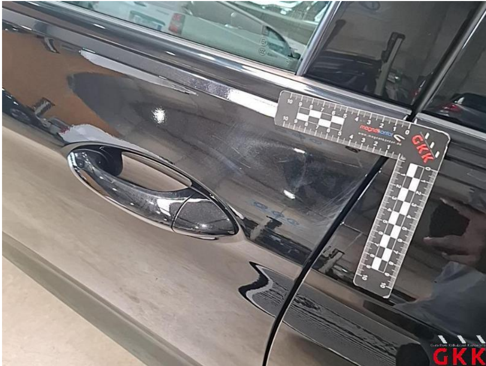
Bild 21. Tür vorne links, verkratzt, Smartrepair
