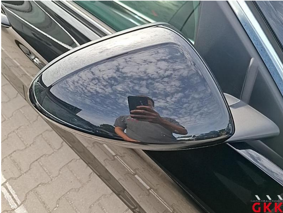
Bild 63. Spiegelgehäuse rechts, Kappe -lackiert-, verkratzt, lackieren
