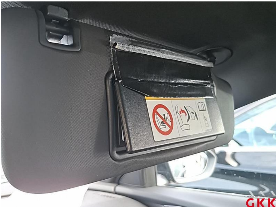
Bild 58. Sonnenblende, rechts, beschädigt, ersetzen
