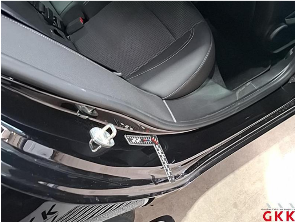
Bild 53. Tür hinten rechts, Einstieg, beschädigt, instand setzen - lackieren
