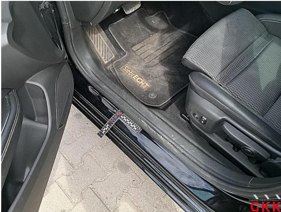
Bild 60. Tür vorne links, Einstieg, verkratzt, lackieren
