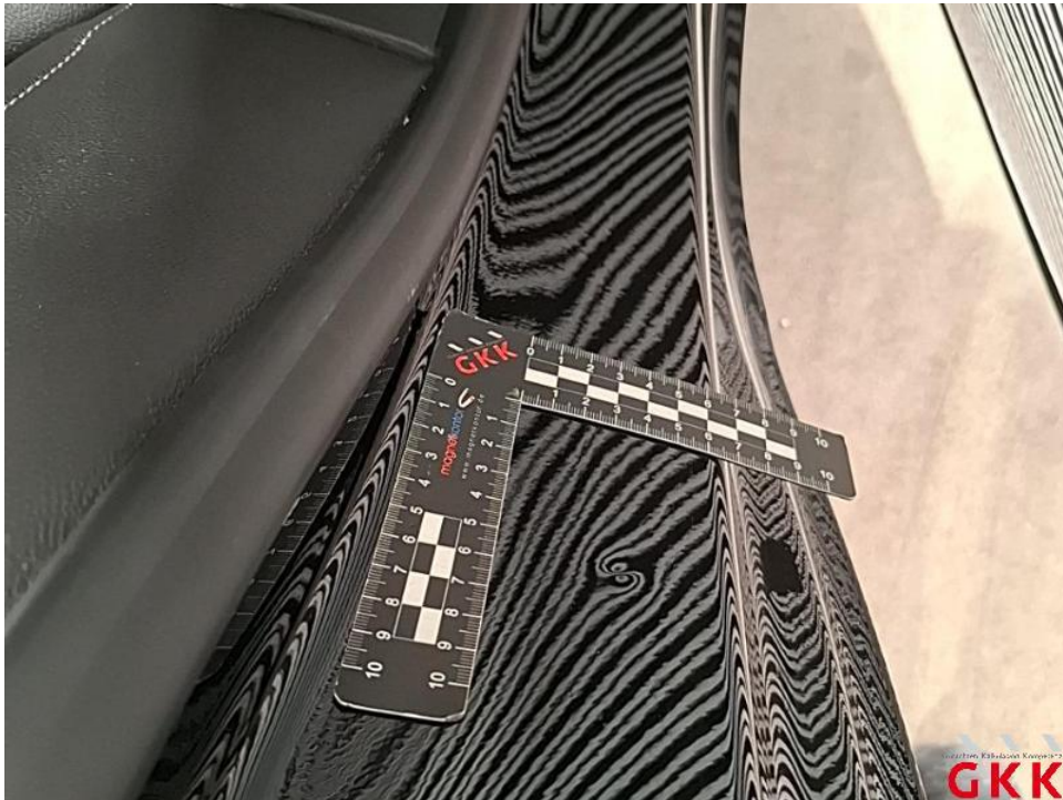
Bild 54. Tür hinten rechts, Einstieg, beschädigt, instand setzen - lackieren
