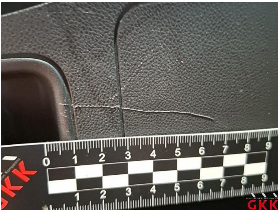
Bild 40. Seitenwand links, Innenverkleidung, beschädigt, ersetzen
