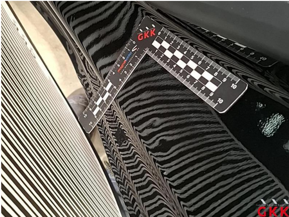
Bild 28. Tür hinten links, Einstieg, beschädigt, instand setzen - lackieren
