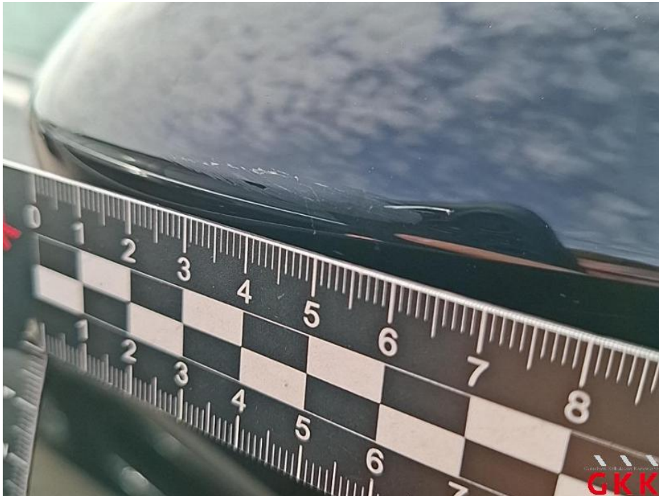
Bild 64. Spiegelgehäuse rechts, Kappe -lackiert-, verkratzt, lackieren
