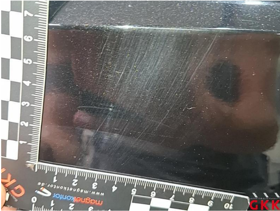
Bild 23. Tür vorne links, verkratzt, Smartrepair
