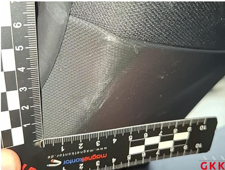
Bild 44. D- Säule links, Innenverkleidung, verkratzt, ersetzen
