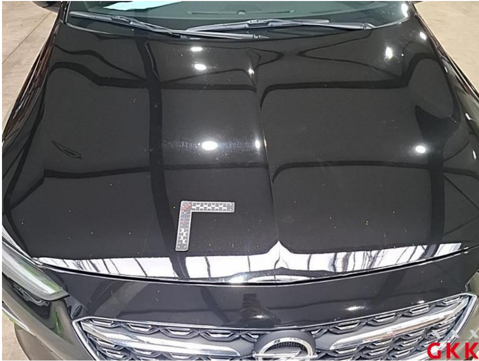
Bild 15. Motorhaube, Steinschlag und Kratzer, lackieren
