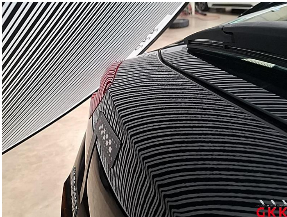
Bild 35. Heckklappe, beschädigt, instand setzen - lackieren
