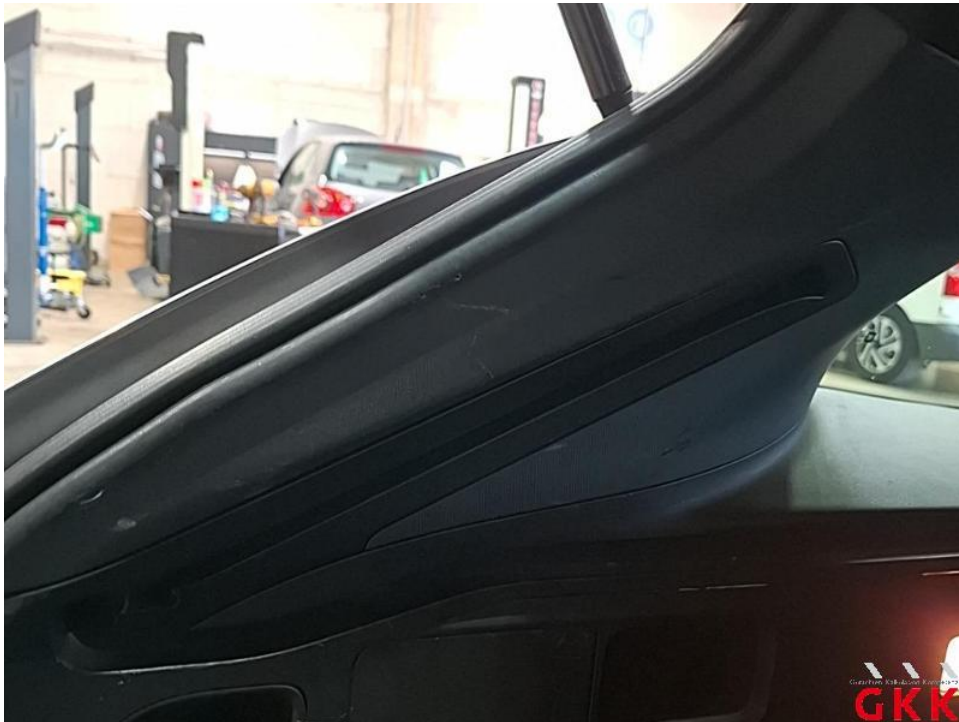
Bild 42. D- Säule links, Innenverkleidung, verkratzt, ersetzen
