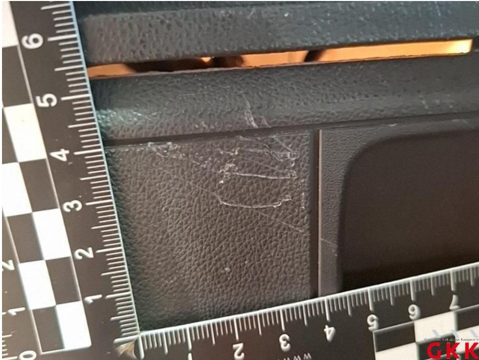
Bild 41. Seitenwand links, Innenverkleidung, beschädigt, ersetzen
