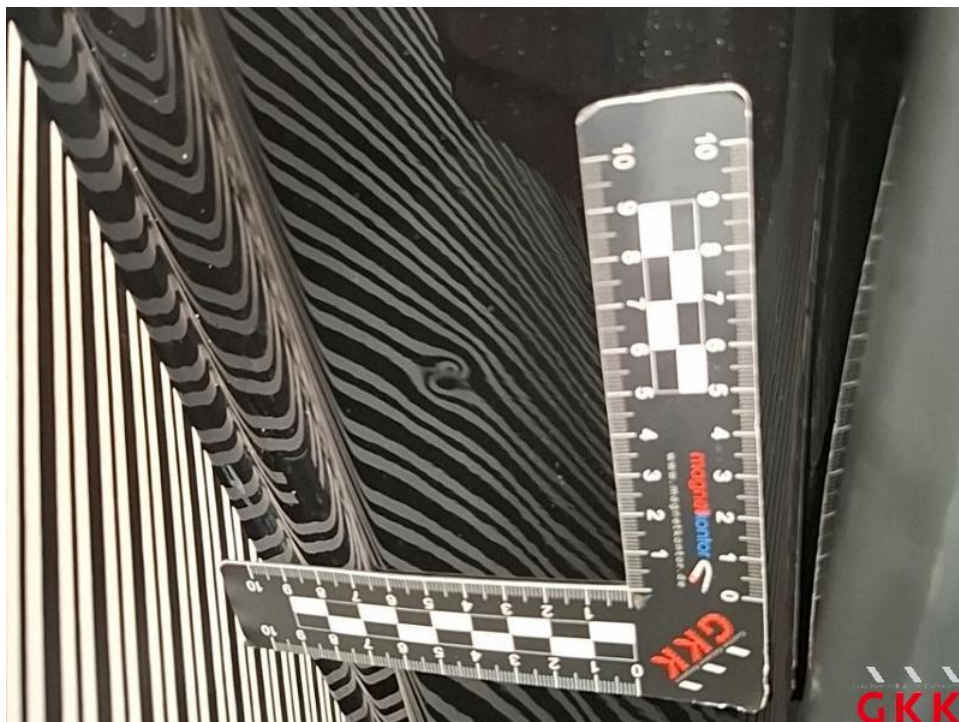
Bild 55. Tür hinten rechts, Einstieg, beschädigt, instand setzen - lackieren
