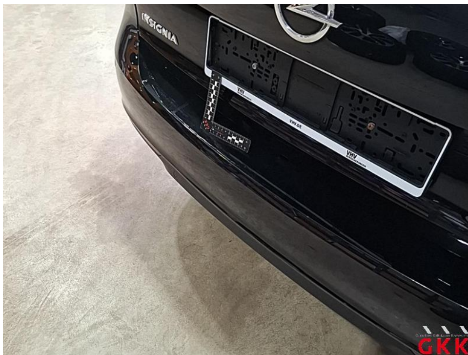
Bild 48. Stoßfänger hinten, Verkleidung -lackiert-, beschädigt, ersetzen
