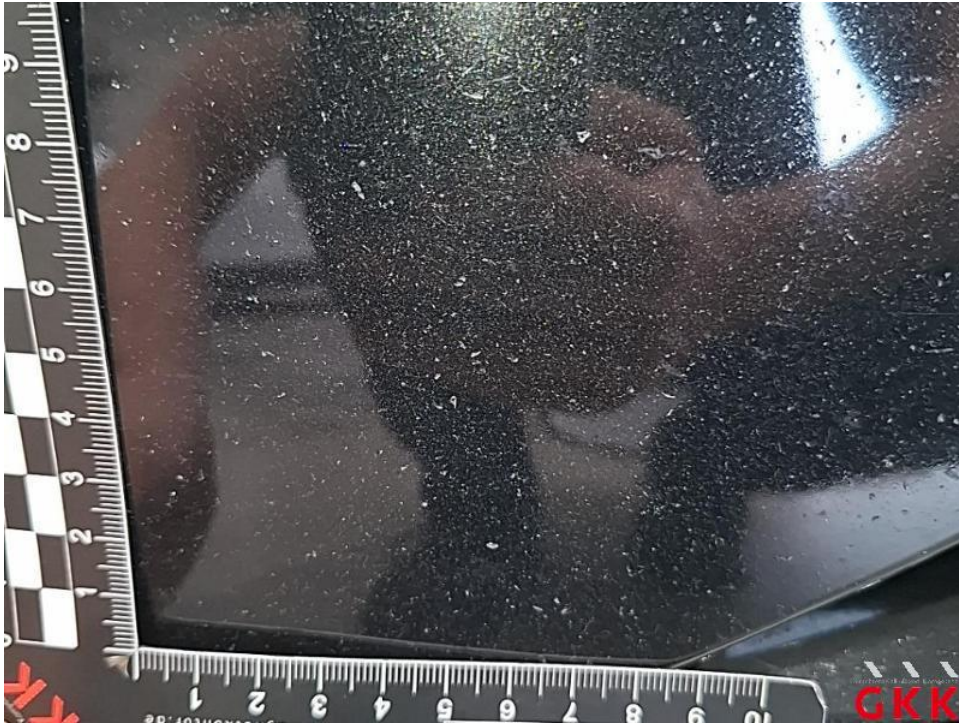
Bild 19. Stoßfänger vorne, Verkleidung -lackiert-, Steinschlag und Kratzer, lackieren
