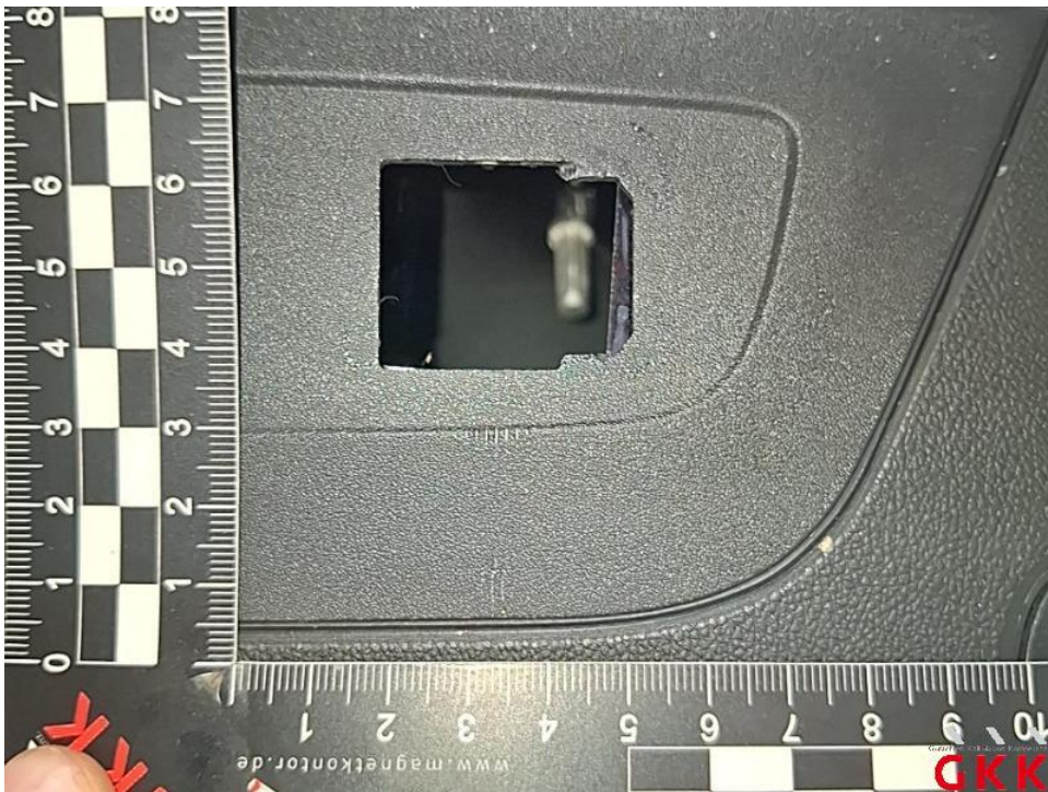
Bild 38. Heckklappe, Innenverkleidung, beschädigt, ersetzen
