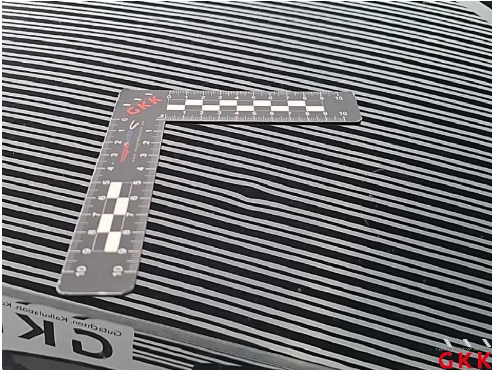
Bild 25. Dach, 4 bis 10 Dellen / Bauteil, kalt drücken
