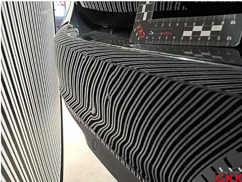
Bild 49. Stoßfänger hinten, Verkleidung -lackiert-, beschädigt, ersetzen
