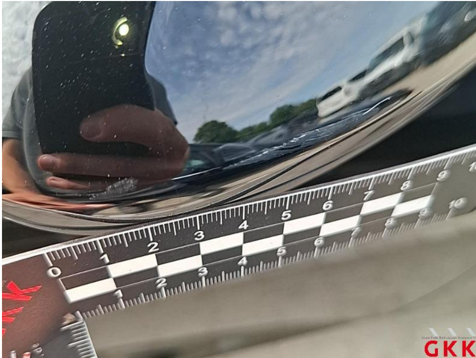
Bild 65. Spiegelgehäuse rechts, Kappe -lackiert-, verkratzt, lackieren
