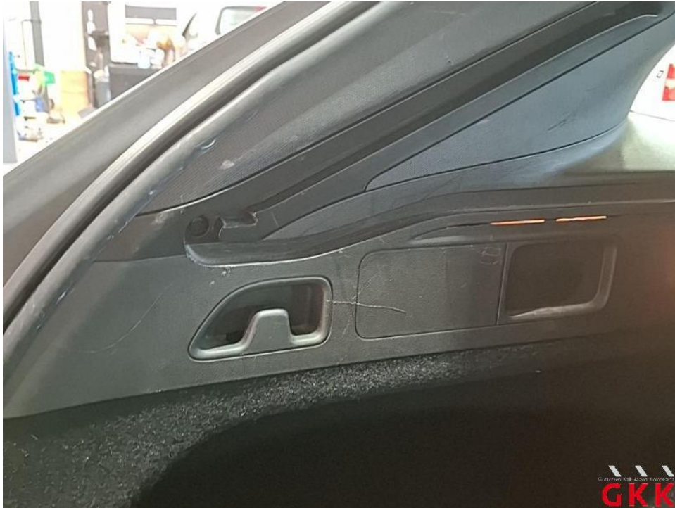
Bild 39. Seitenwand links, Innenverkleidung, beschädigt, ersetzen
