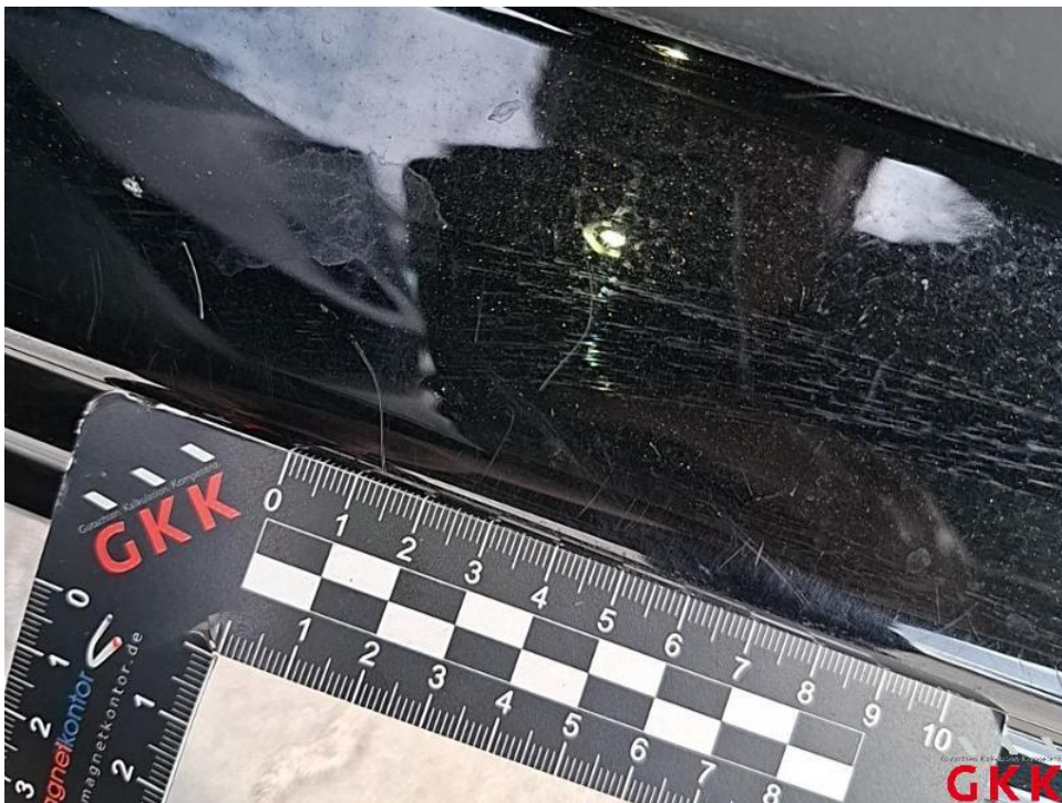
Bild 62. Tür vorne links, Einstieg, verkratzt, lackieren
