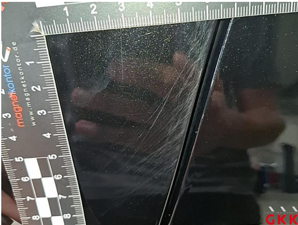
Bild 22. Tür vorne links, verkratzt, Smartrepair
