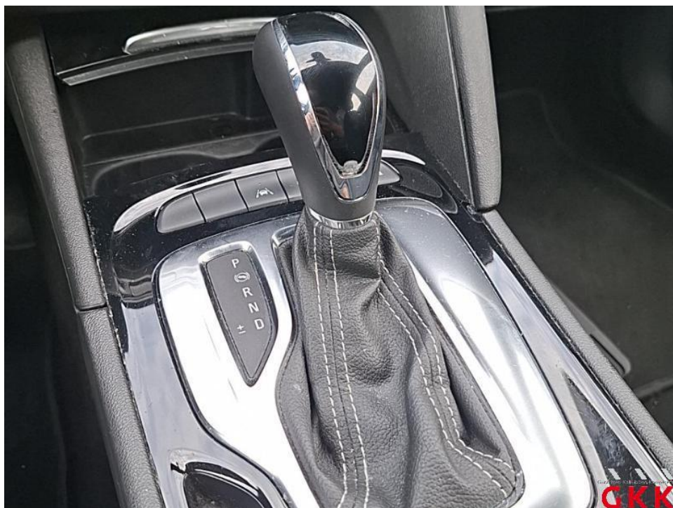
Bild 56. Schalthebel, Knauf -Leder-, beschädigt, ersetzen
