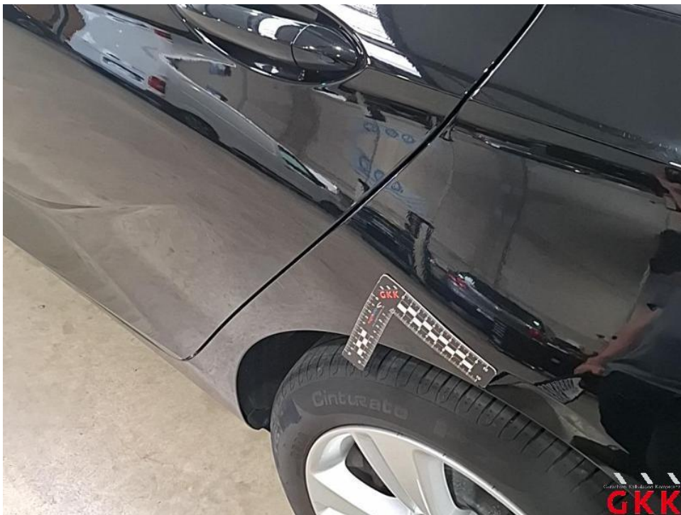
Bild 30. Seitenwand links, beschädigt, instand setzen - lackieren
