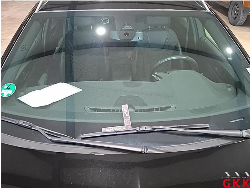
Bild 13. Frontscheibe, mit Regensensor und Frontkamera, Steinschlag mit Rissbildung, ersetzen
