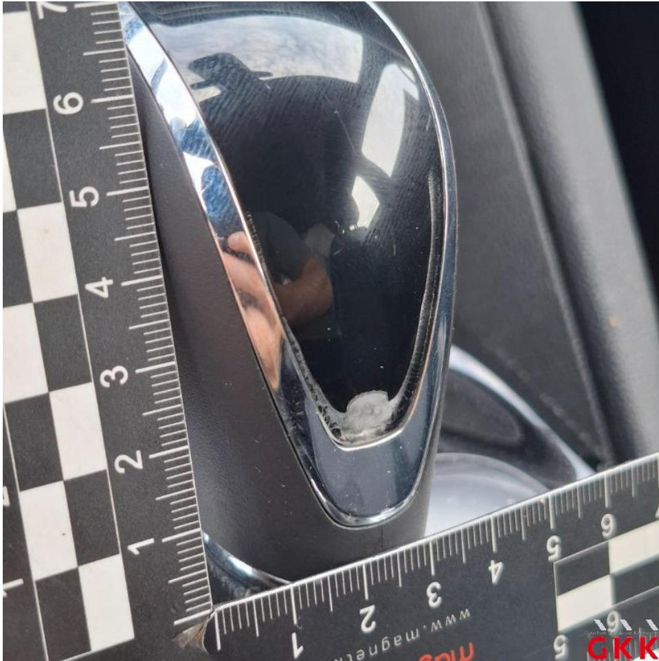
Bild 57. Schalthebel, Knauf -Leder-, beschädigt, ersetzen
