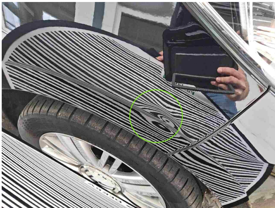
Bild 19 : Delle Kotflügel rechts
