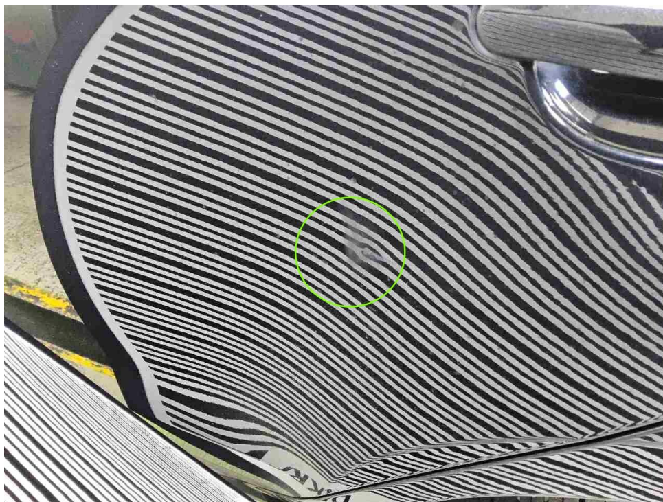
Bild 18 : Delle Tür hinten links
