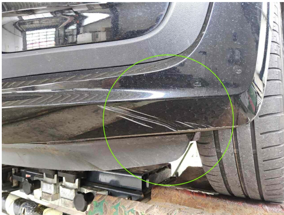
Bild 23 : Stoßfänger vorn zerkratzt
