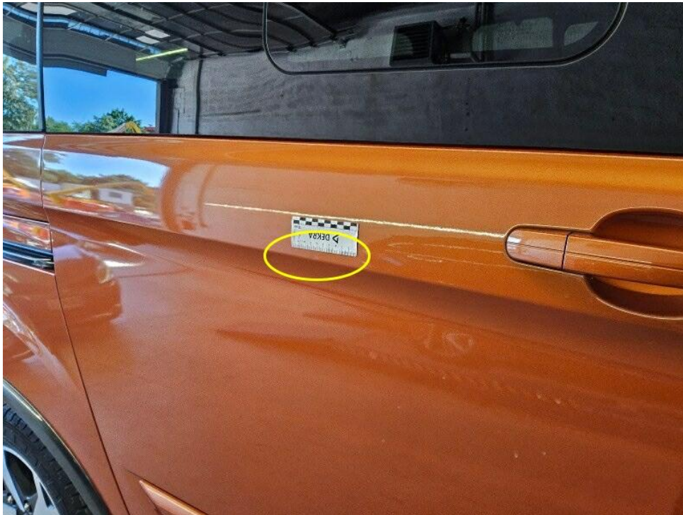
Bild 29 : Tür hinten rechts Lackierung, zerkratzt, smart repair
