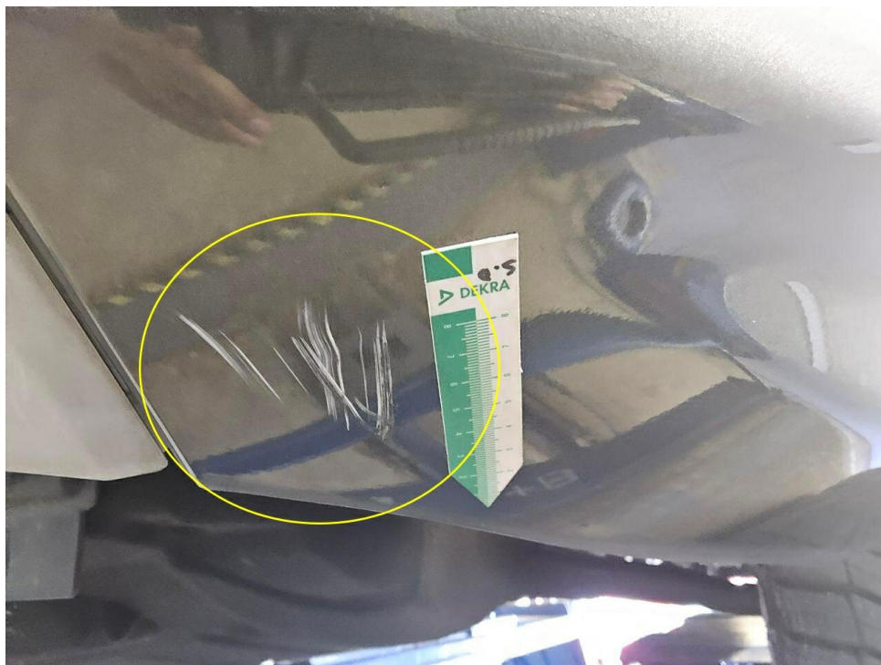
Bild 25 : Stoßfänger vorne Lackierung, zerkratzt, smart repair
