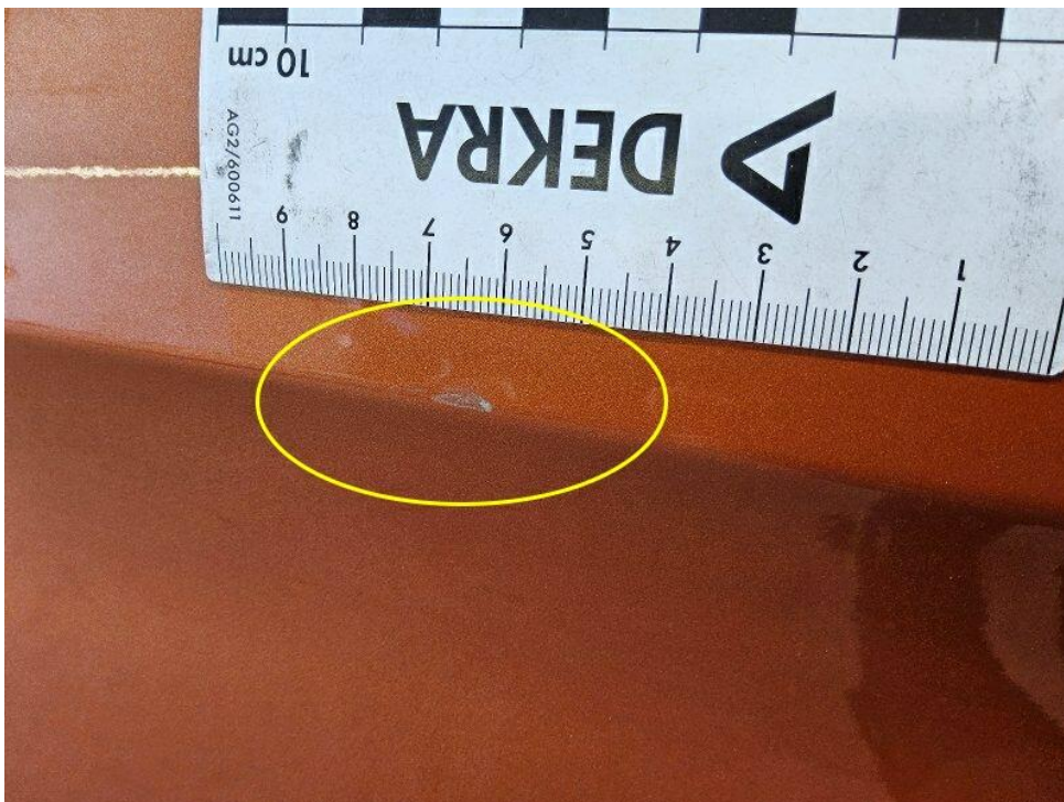
Bild 30 : Tür hinten rechts Lackierung, zerkratzt, smart repair
