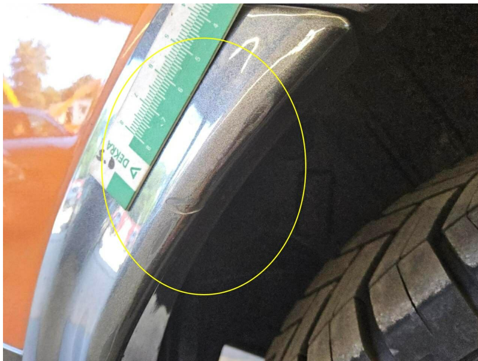
Bild 15 : Stoßfänger hinten Rammschutzleiste rechts Lackierung, zerkratzt, smart repair
