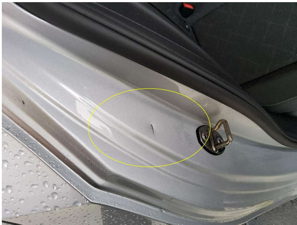
Bild 16 : Einstieg hinten rechts verschrammt und verformt.
