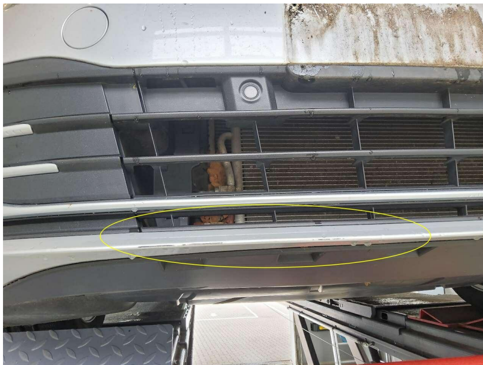
Bild 17 : Stoßfänger vorne unterhalb verschrammt.
