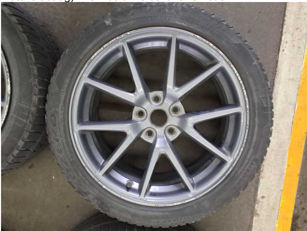
Beschädigung #10: 2.Radsatz: 2 Leichtmetallfelgen (Winter, Materialabtrag) - verkratzt / verschürft - erneuern
