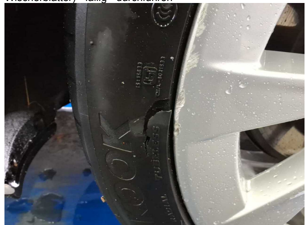
Beschädigung #5: Rad/Reifen: Reifen hinten links (Sommer) - beschädigt - erneuern
