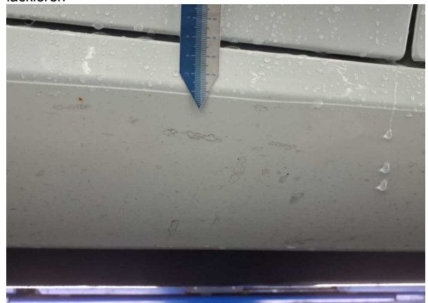
Beschädigung #7: Schweller rechts: Schweller - Lackmangel - lackieren
