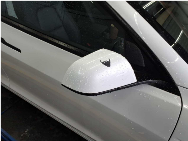
Beschädigung #6: Außenspiegel rechts: Abdeckkappe - Lackmangel - lackieren
