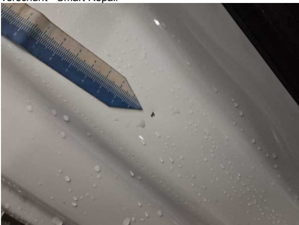
Beschädigung #2: Seitenwand rechts: Einstieg - Delle / Lackschade... Smart Repair
