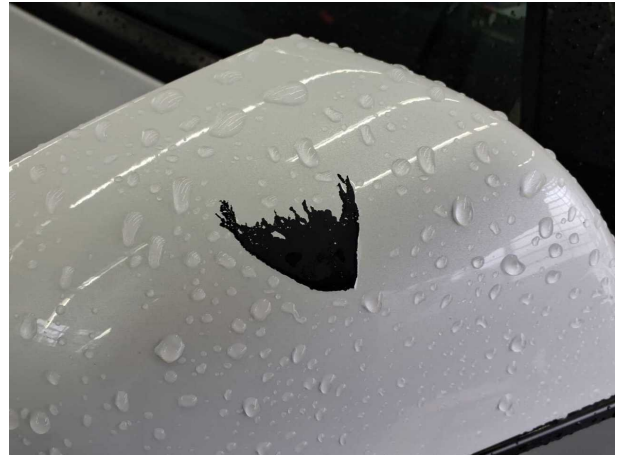
Beschädigung #6: Außenspiegel rechts: Abdeckkappe - Lackmangel - lackieren
