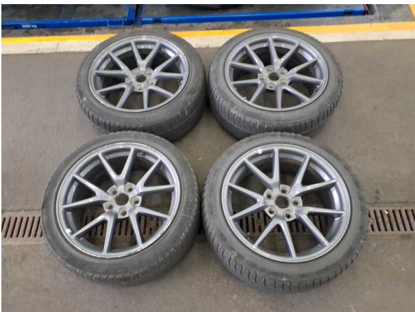
Beschädigung #9: 2.Radsatz: Reifensatz komplett (Winter, Profiltiefe <4mm) - verschlissen - erneuern
