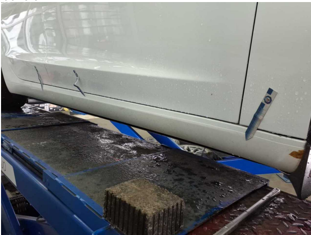
Beschädigung #7: Schweller rechts: Schweller - Lackmangel - lackieren
