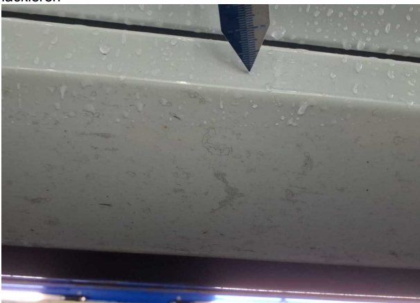
Beschädigung #7: Schweller rechts: Schweller - Lackmangel - lackieren
