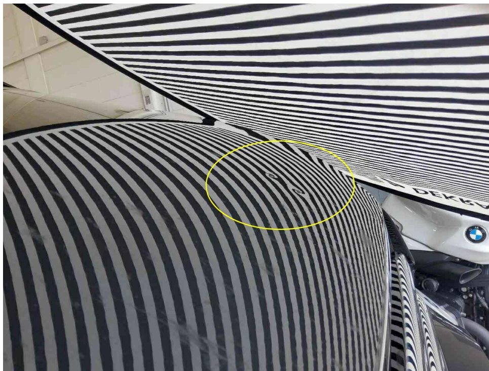
Bild 24 : Motorhaube Dellen mit Lackbeschädigung
