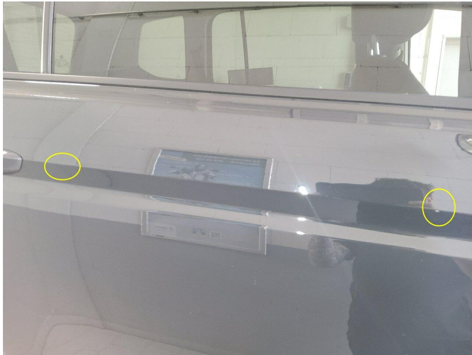
Bild 31 : Türe hinten rechts Lackabplatzer
