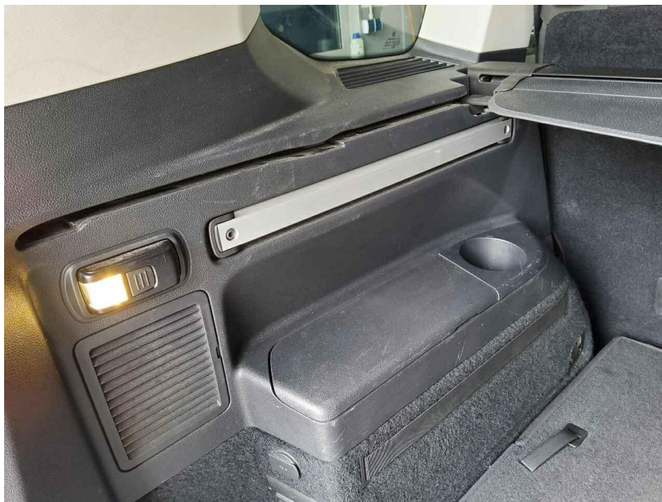
Bild 30 : Laderaum mehrere Kratzer und Abschürfungen
