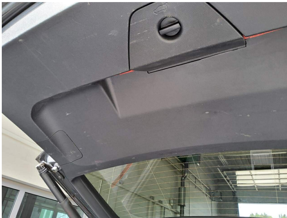
Bild 29 : Laderaum mehrere Kratzer und Abschürfungen
