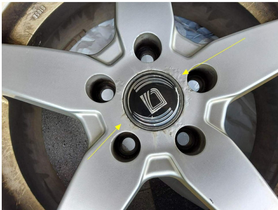
Bild 15 : 4x Zubehör Leichtmetallfelgen Korrosion
