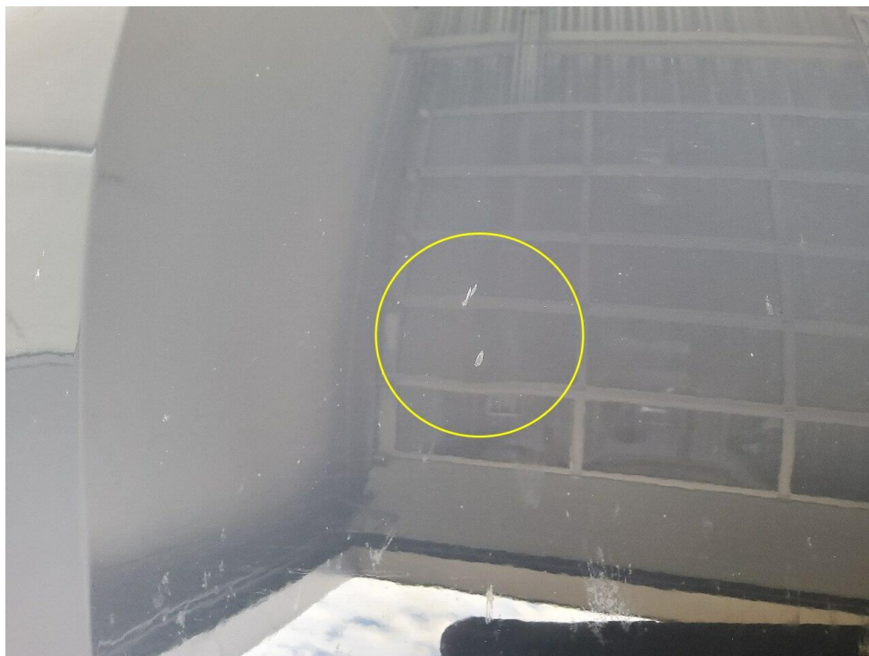
Bild 23 : Motorhaube Dellen mit Lackbeschädigung
