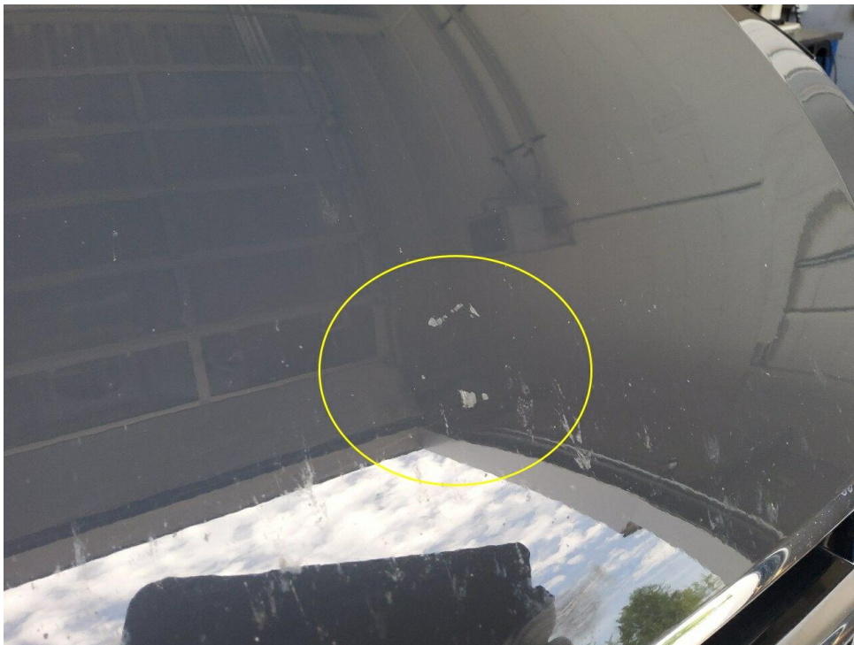
Bild 22 : Motorhaube Dellen mit Lackbeschädigung
