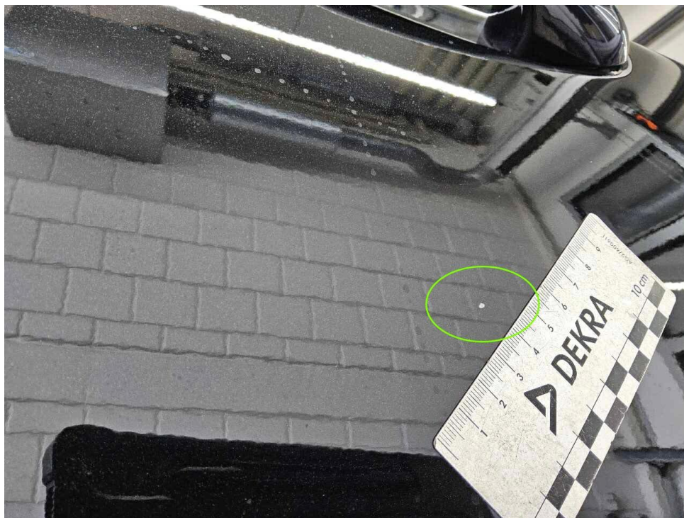
Bild 14 : Tür hinten links Lackabplatzung
