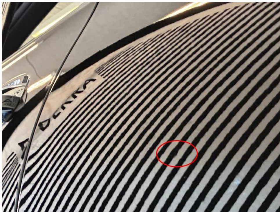
Bild 17 : Türe hinten links Kratzer + Delle
