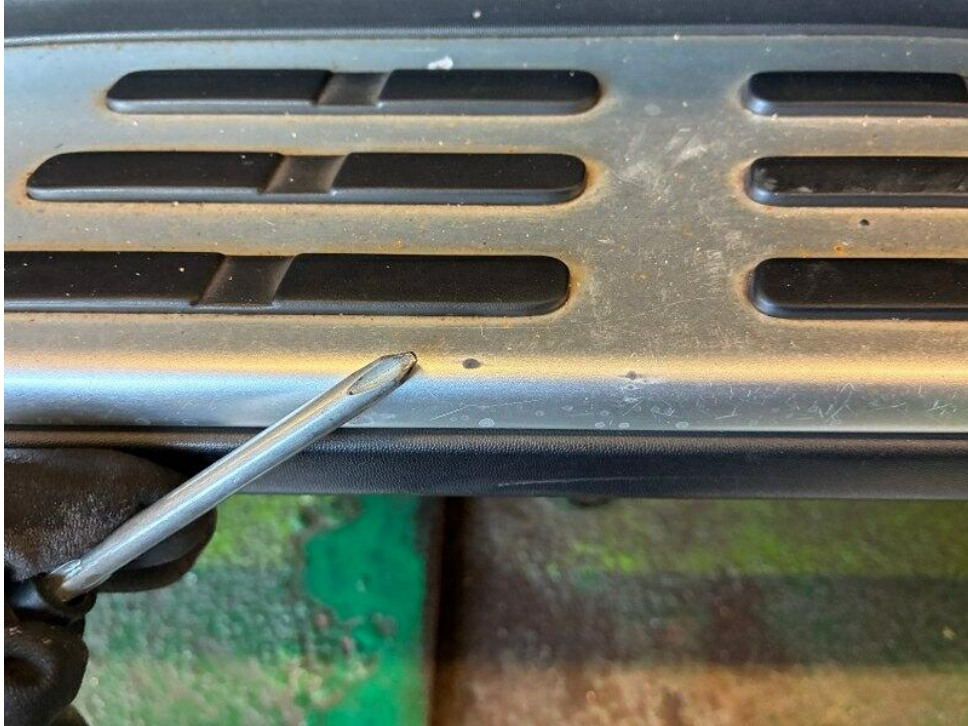
Bild 21 : Schweller links Kratzer + Delle
