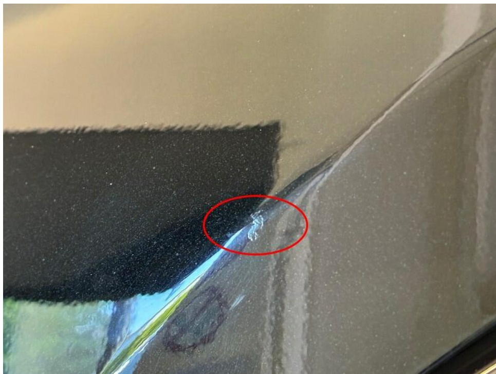
Bild 18 : Türe hinten links Kratzer + Delle
