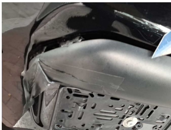
Damage 3: Boot lid / rear door: Rear door - left side (Blende Kennzeichenleuchte) - Broken / torn - Replace
