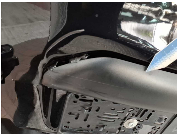
Damage 3: Boot lid / rear door: Rear door - left side (Blende Kennzeichenleuchte) - Broken / torn - Replace
