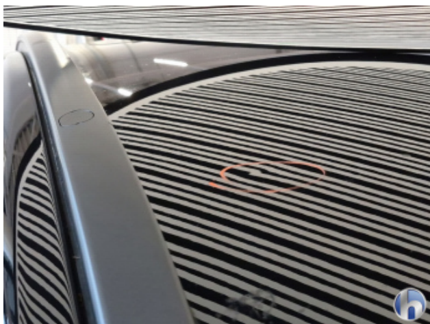
3. Dach 1 Delle - Sanft Instandsetzen
