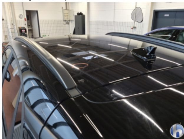
3. Dach 1 Delle - Sanft Instandsetzen
