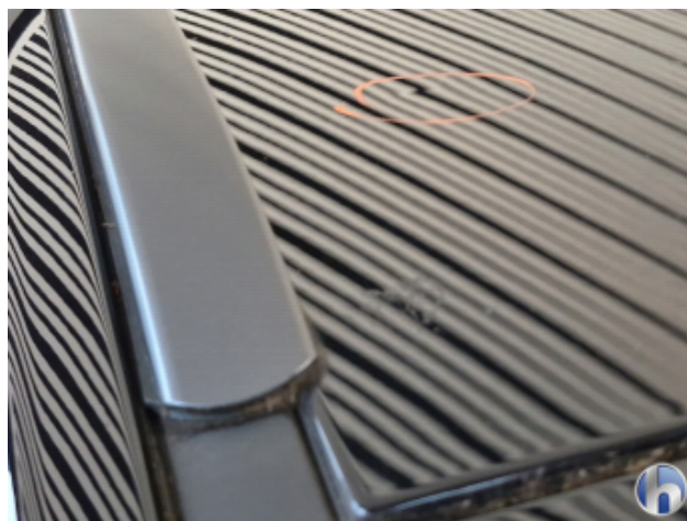
3. Dach 1 Delle - Sanft Instandsetzen
