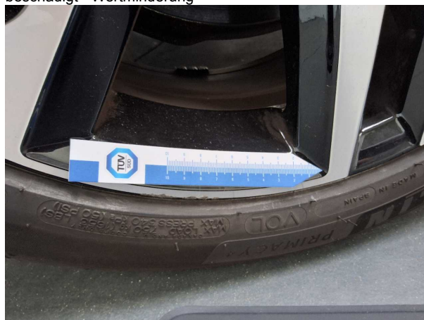
Beschädigung #2: Rad/Reifen: Leichtmetallfelge vorn links - beschädigt - Wertminderung
