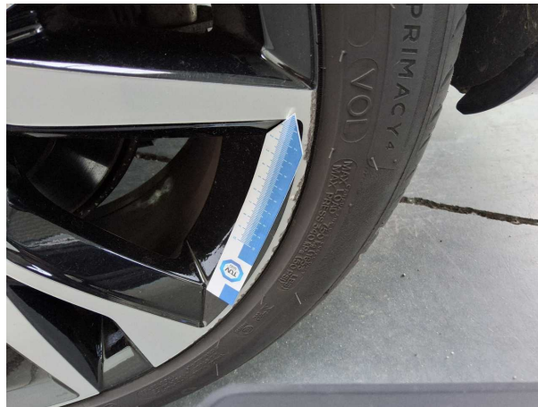
Beschädigung #1: Rad/Reifen: Leichtmetallfelge hinten links - beschädigt - Wertminderung
