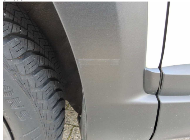
Beschädigung #2: Seitenwand rechts: Radlauf - verkratzt / verschürft - erneuern
