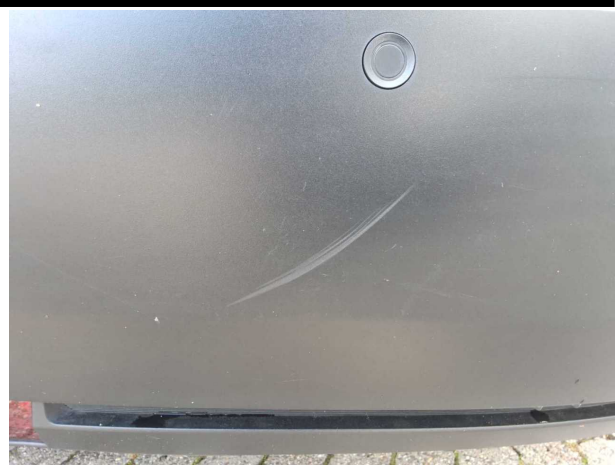
Beschädigung #7: Stossfänger hinten: Stossfänger hinten - Kratzer - instandsetzen und lackieren
