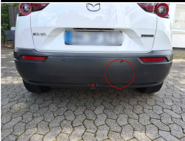
Beschädigung #7: Stossfänger hinten: Stossfänger hinten - Kratzer - instandsetzen und lackieren
