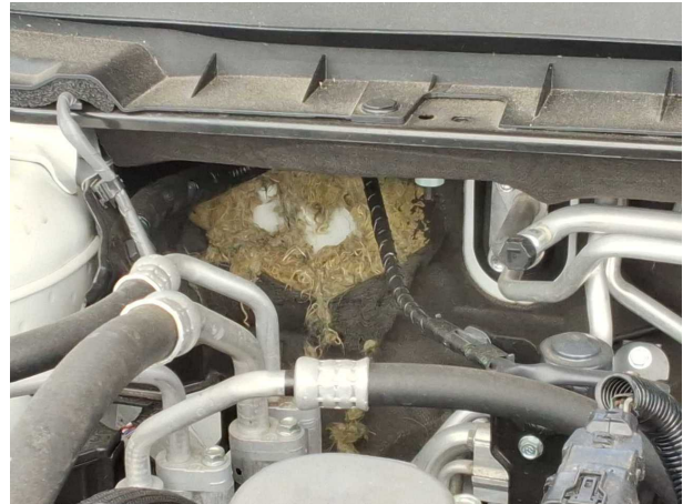
Beschädigung #1: Motorhaube: Dämmmatte - beschädigt / erneuern
