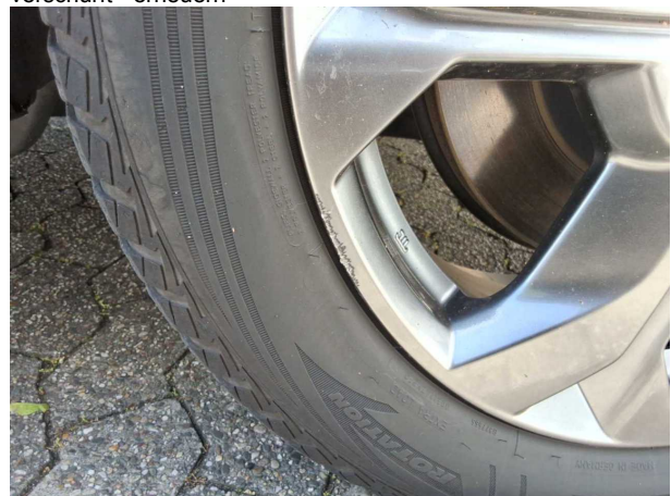
Beschädigung #6: Rad/Reifen: Leichtmetallfelge vorn rechts - Kratzer - erneuern
