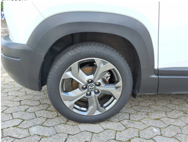
Beschädigung #2: Seitenwand rechts: Radlauf - verkratzt / verschürft - erneuern
