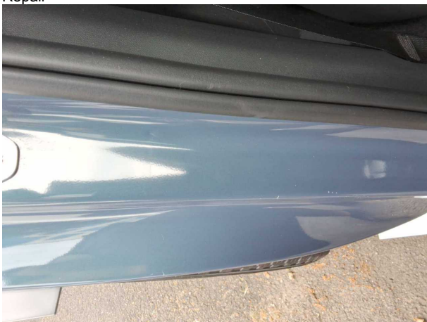
Beschädigung #2: Seitenwand rechts: Einstieg - Delle(n) - sanft instandsetzen
