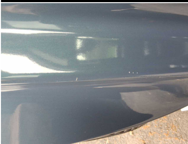
Beschädigung #2: Seitenwand rechts: Einstieg - Delle(n) - sanft instandsetzen
