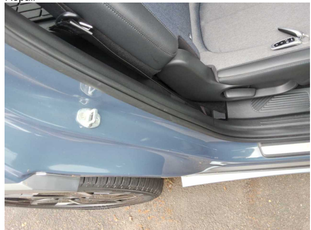
Beschädigung #2: Seitenwand rechts: Einstieg - Delle(n) - sanft instandsetzen
