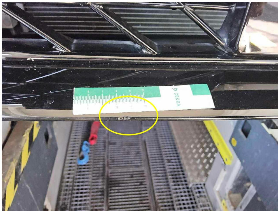
Bild 18 : Stoßfänger vorn verschrammt
