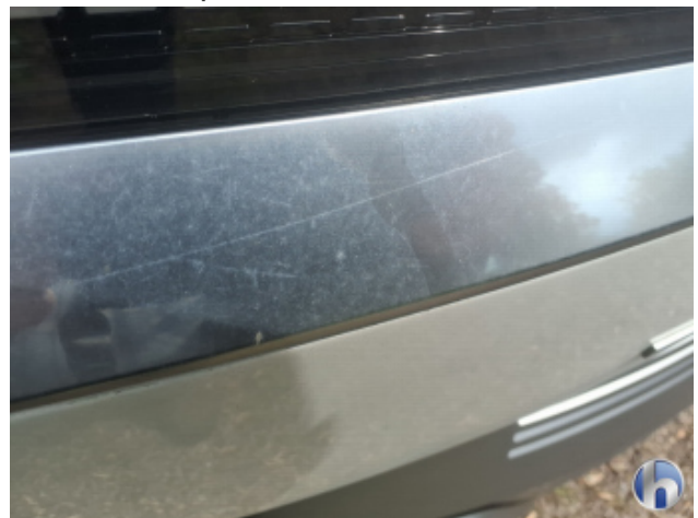
7. Zierelement Heckklappe Beschädigt - Erneuern
