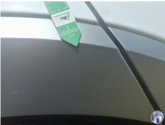
3. Seitenwand - Hinten - Rechts Lackabplatzer - Smart Repair
