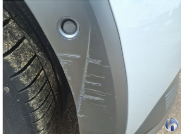
12. Radlaufblende re.vo. Abschürfung - Lackieren
