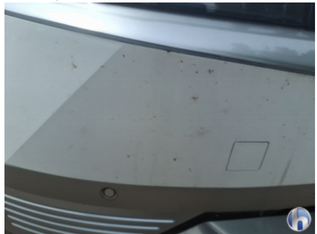
4. Stoßfänger Vorne Steinschlag - Lackieren
