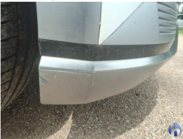
6. Frontspoiler Kratzer - Lackieren
