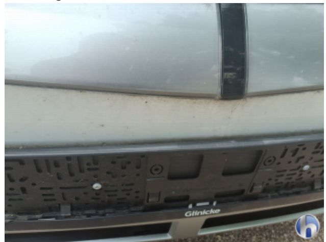
4. Stoßfänger Vorne Steinschlag - Lackieren
