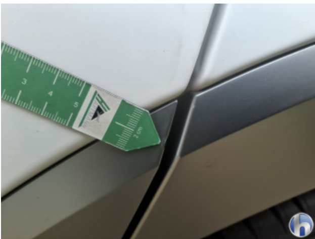
11. Seitenschutzleiste li.hi. Beschädigt - Smart Repair
