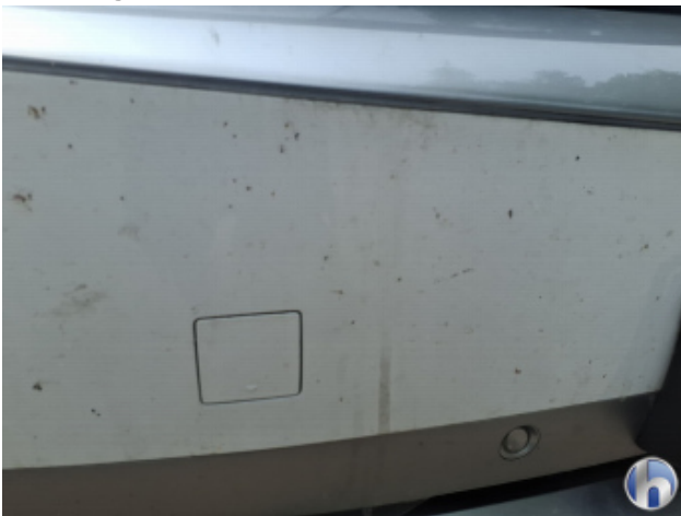
4. Stoßfänger Vorne Steinschlag - Lackieren
