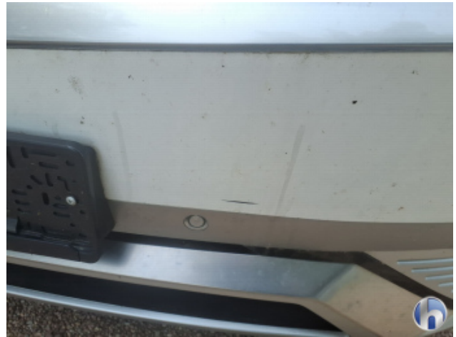
4. Stoßfänger Vorne Steinschlag - Lackieren
