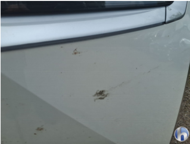
4. Stoßfänger Vorne Steinschlag - Lackieren
