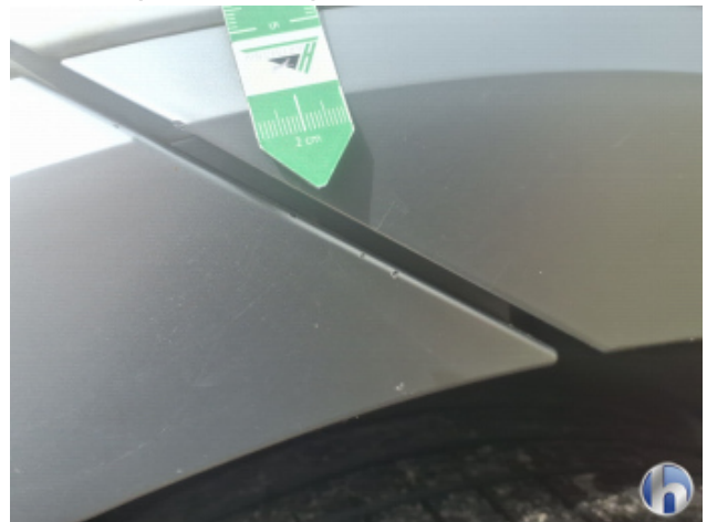
3. Seitenwand - Hinten - Rechts Lackabplatzer - Smart Repair
