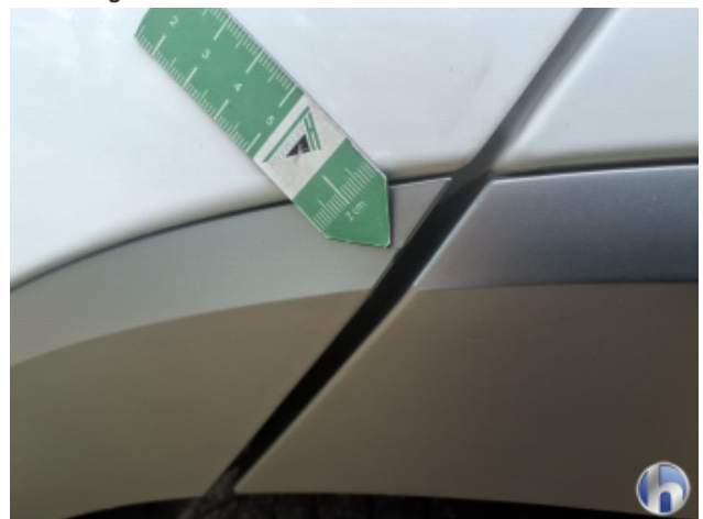
11. Seitenschutzleiste li.hi. Beschädigt - Smart Repair
