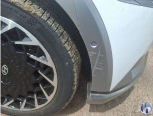
12. Radlaufblende re.vo. Abschürfung - Lackieren
