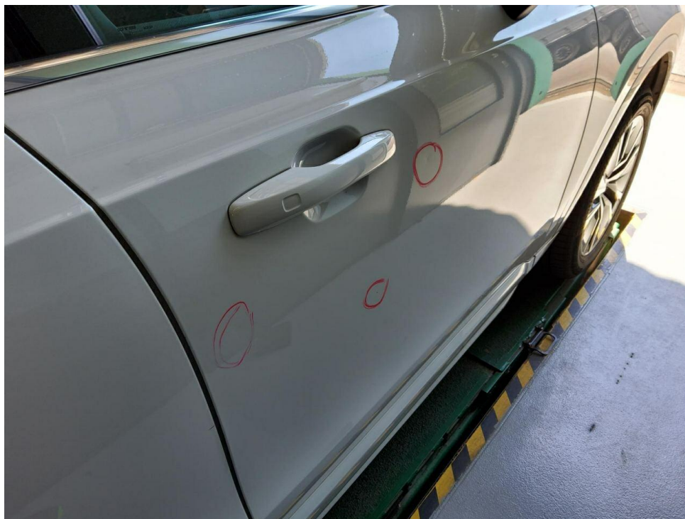
Bild 14 : Tür vorne rechts, deformiert, smart repair
