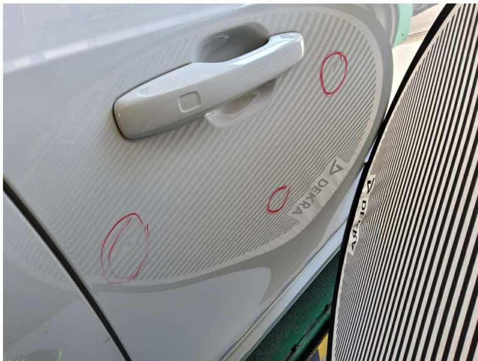
Bild 15 : Tür vorne rechts, deformiert, smart repair
