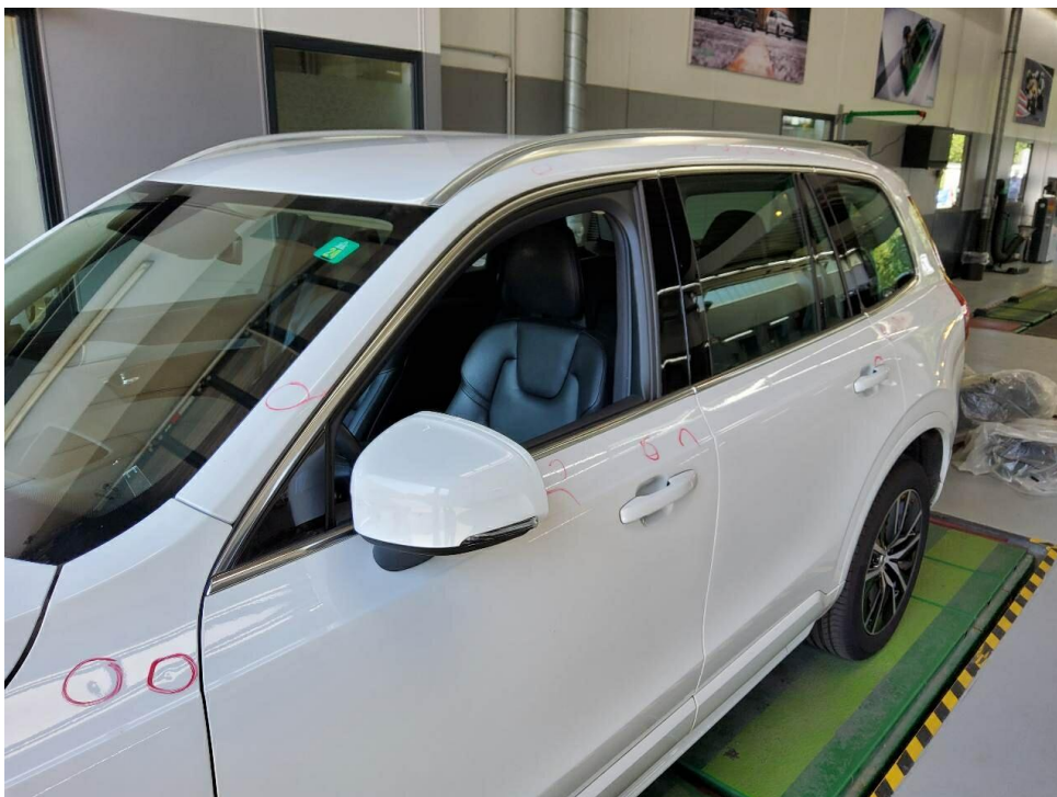
Bild 28 : Elementarschaden. Separates Gutachten erforderlich. Kosten geschätzt
