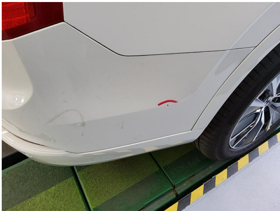
Bild 19 : Stoßfänger hinten Lackierung, zerkratzt, lackieren mit Lackaufbau
