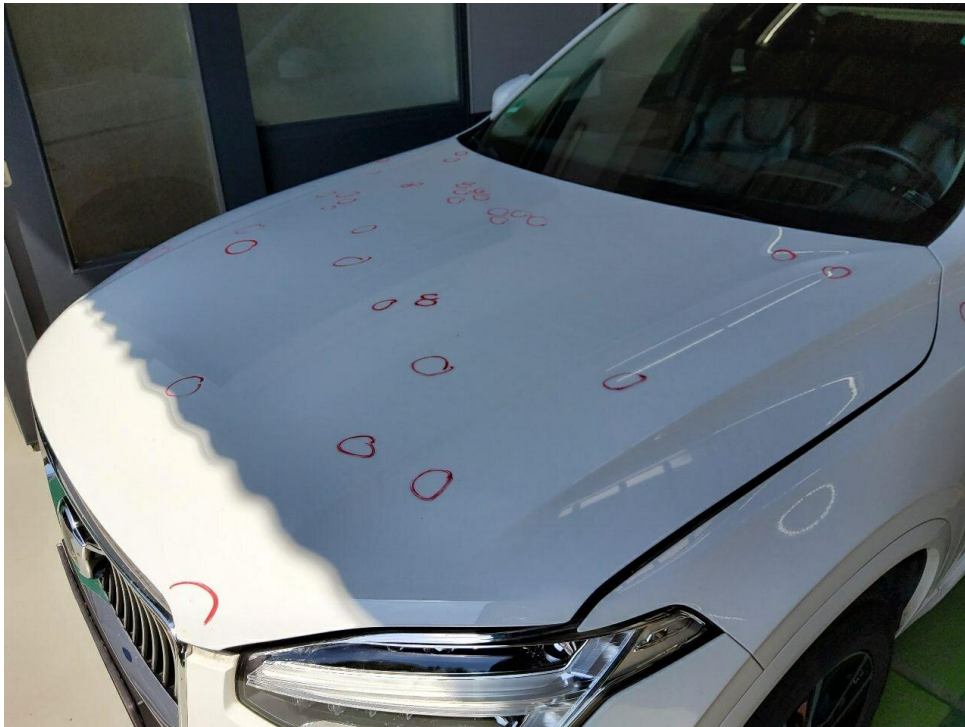
Bild 27 : Elementarschaden. Separates Gutachten erforderlich. Kosten geschätzt
