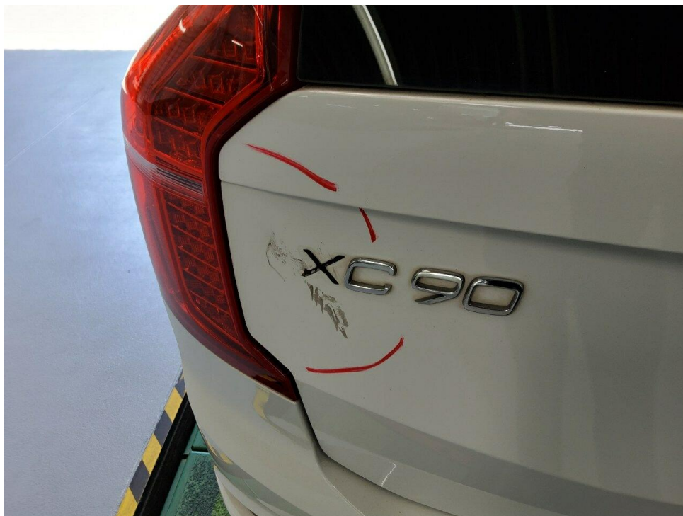
Bild 35 : Typbezeichnung Heckklappe, beschädigt
