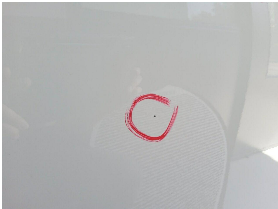
Bild 16 : Tür vorne rechts, deformiert, smart repair
