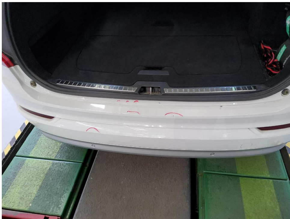
Bild 17 : Stoßfänger hinten Lackierung, zerkratzt, lackieren mit Lackaufbau
