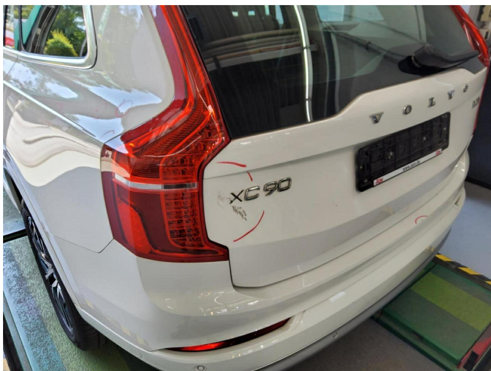
Bild 20 : Heckklappe, deformiert, instandsetzen und lackieren mit Lackaufbau
