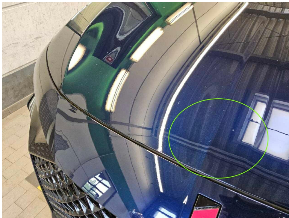
Bild 16 : Motorhaube Lackierung, Steinschlag, Gebrauchsspur
