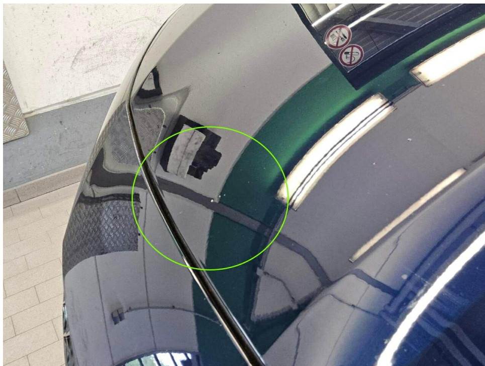
Bild 15 : Motorhaube, eingedellt, Gebrauchsspur
