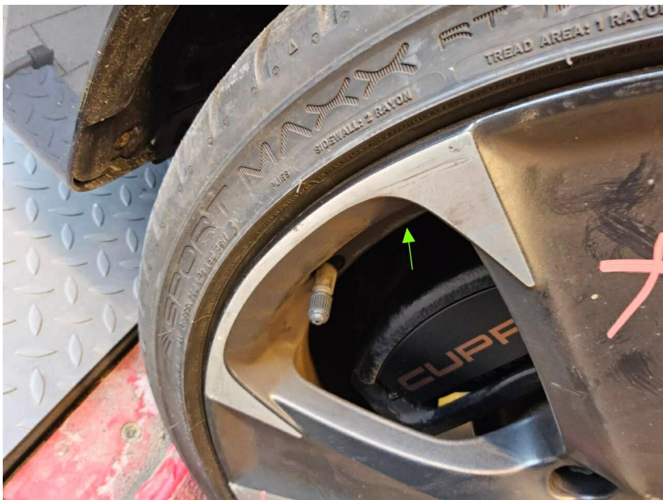
Bild 29 : Felgen vorne links deformiert
