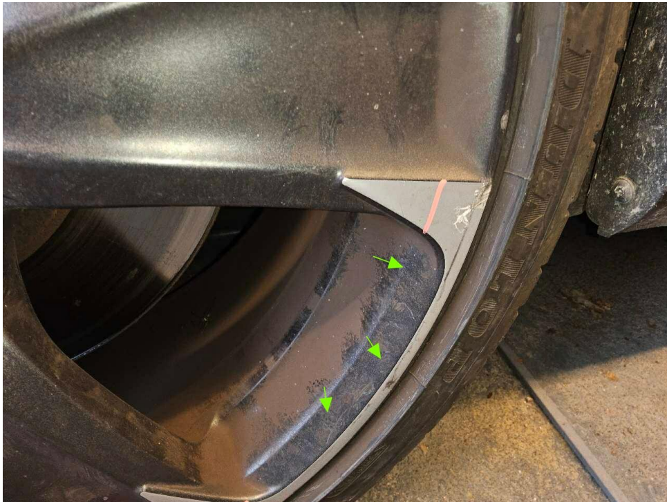
Bild 28 : Felgen vorne links deformiert
