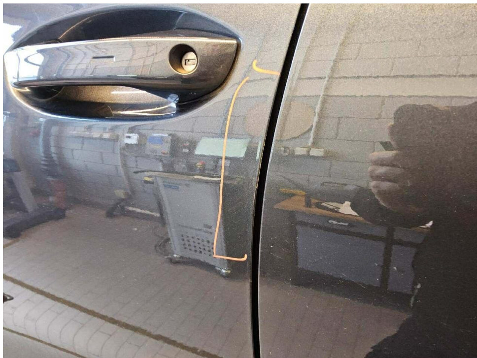
Bild 19 : Tür vorne links Türkante, verschrammt, smart repair
