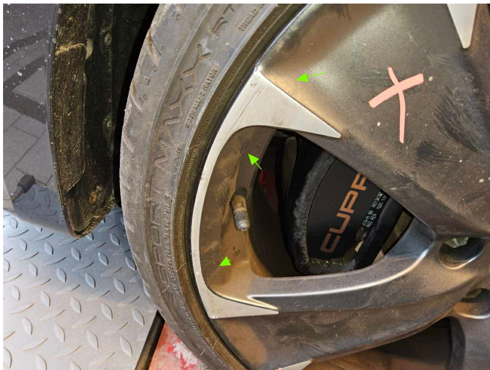
Bild 26 : Felgen vorne links deformiert
