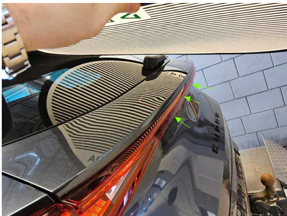
Bild 25 : Heckklappe, mehrfach eingedellt, drücken
