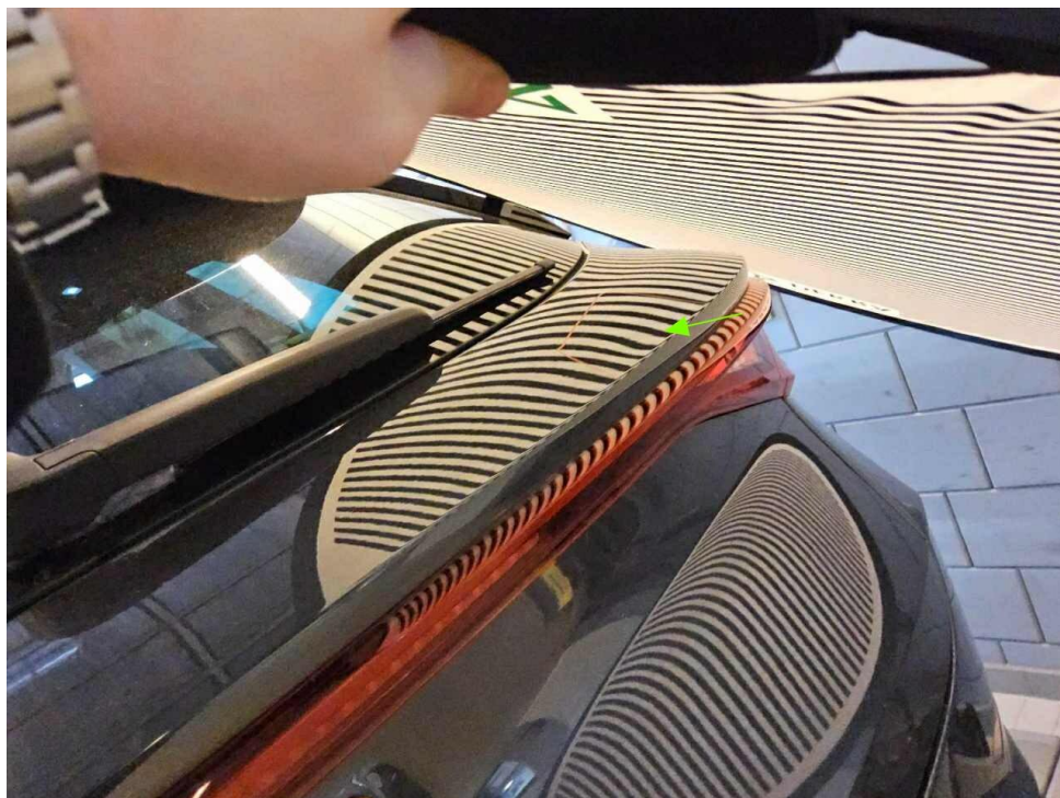
Bild 24 : Heckklappe, mehrfach eingedellt, drücken
