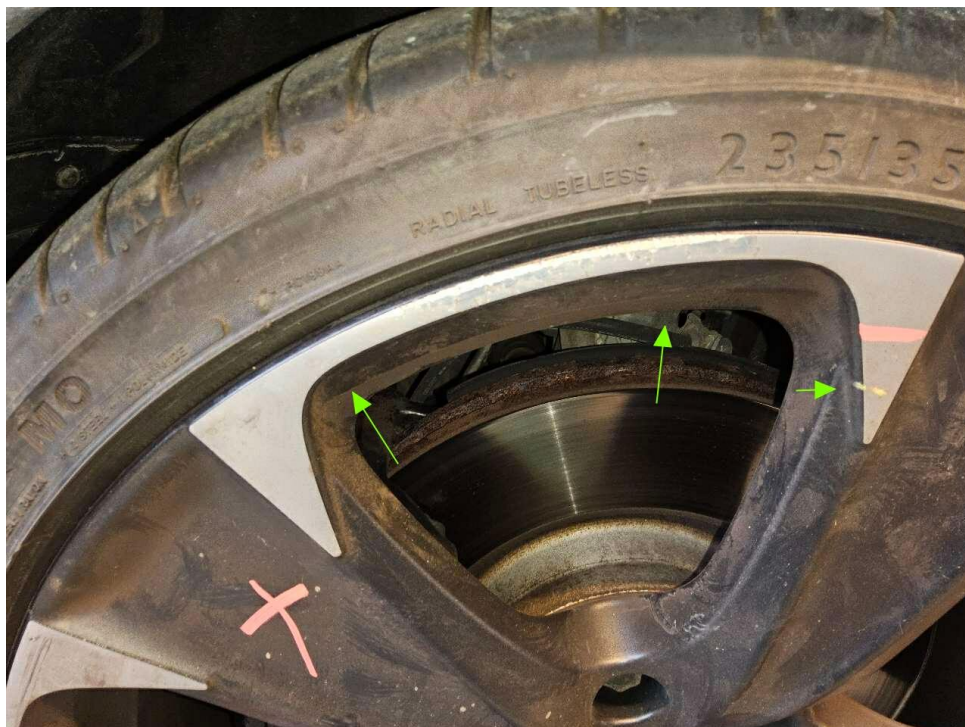
Bild 27 : Felgen vorne links deformiert
