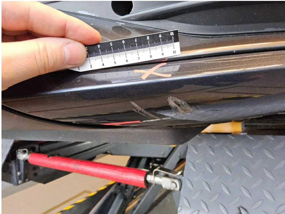
Bild 20 : Stoßfänger vorne, verschrammt, smart repair
