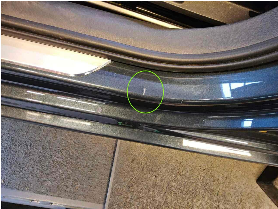
Bild 30 : Einstieg vorne links verschrammt
