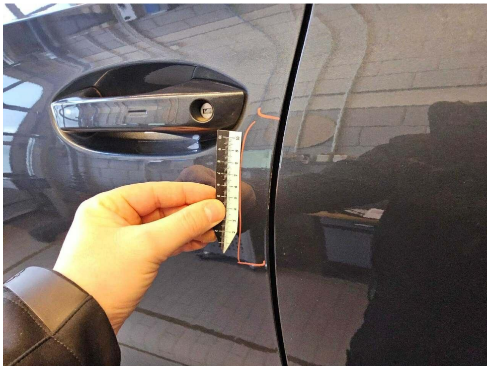
Bild 18 : Tür vorne links Türkante, verschrammt, smart repair
