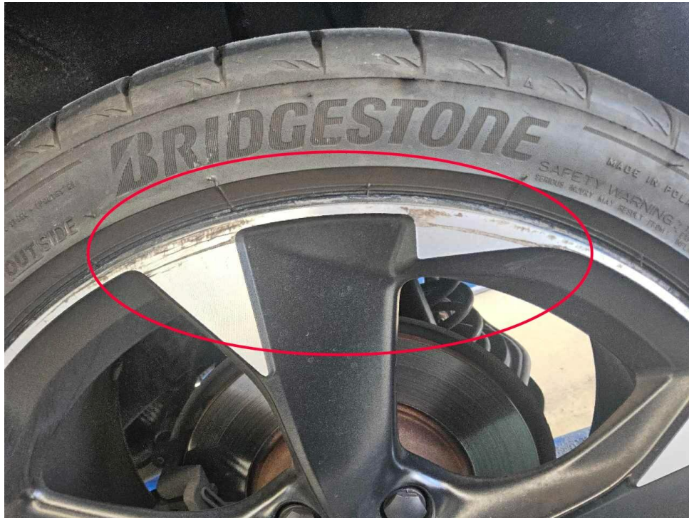
Bild 25 : LM Felge hinten links, glanzgedreht, verschrammt
