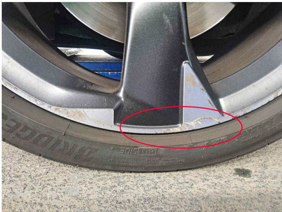
Bild 22 : LM Felge vorne rechts, glanzgedreht, verschrammt incl. kappe fehlt
