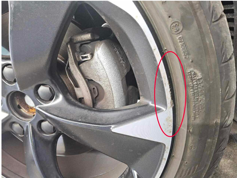
Bild 21 : LM Felge vorne rechts, glanzgedreht, verschrammt incl. kappe fehlt
