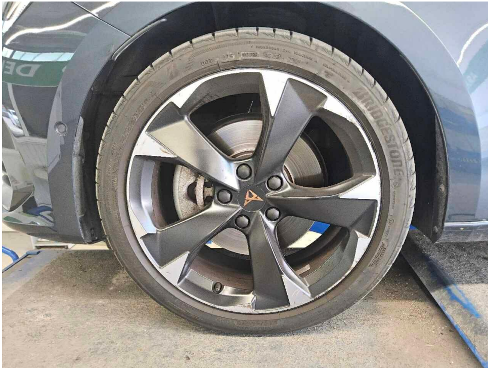
Bild 27 : LM Felge vorne links, glanzgedreht, verschrammt
