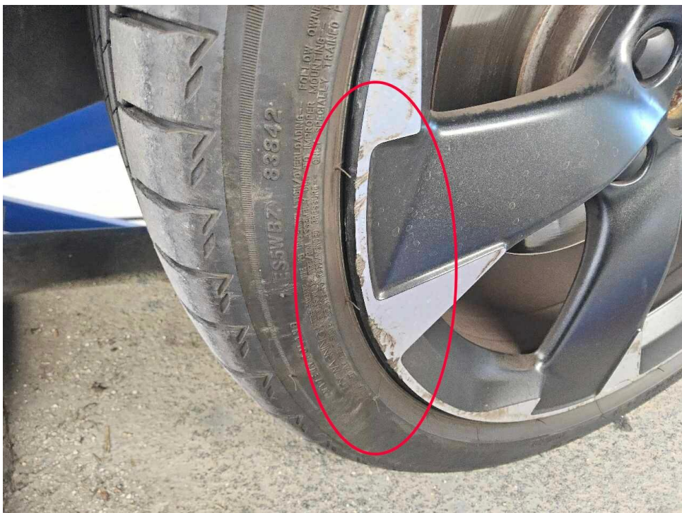
Bild 24 : LM Felge vorne rechts, glanzgedreht, verschrammt incl. kappe fehlt
