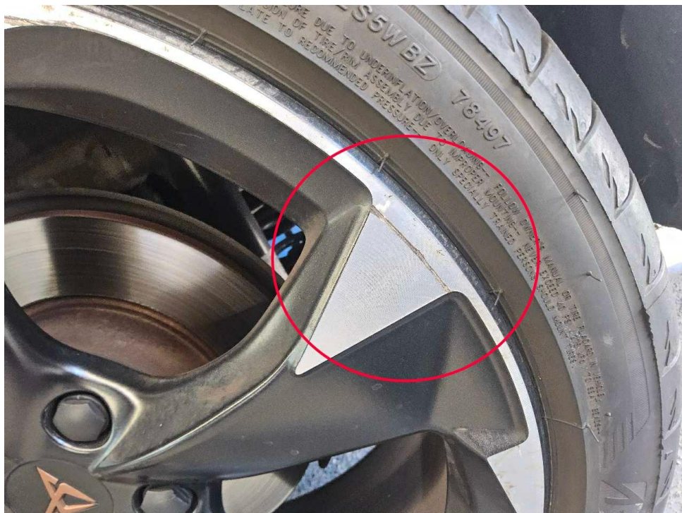
Bild 26 : LM Felge hinten links, glanzgedreht, verschrammt
