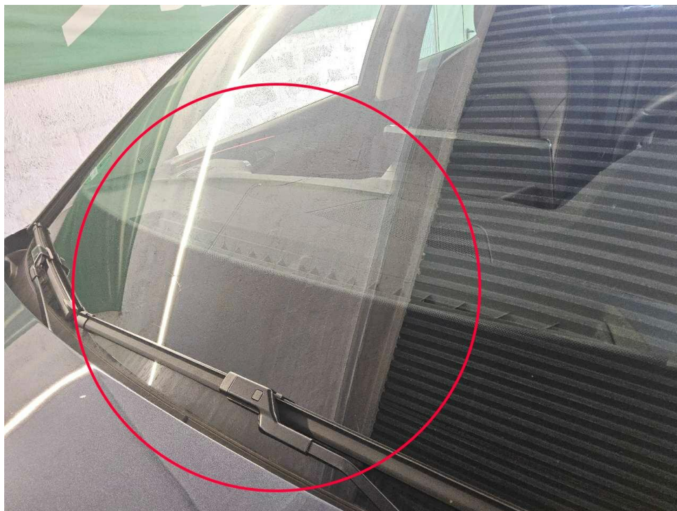
Bild 17 : Frontscheibe Steinschlag mit Rissbildung
