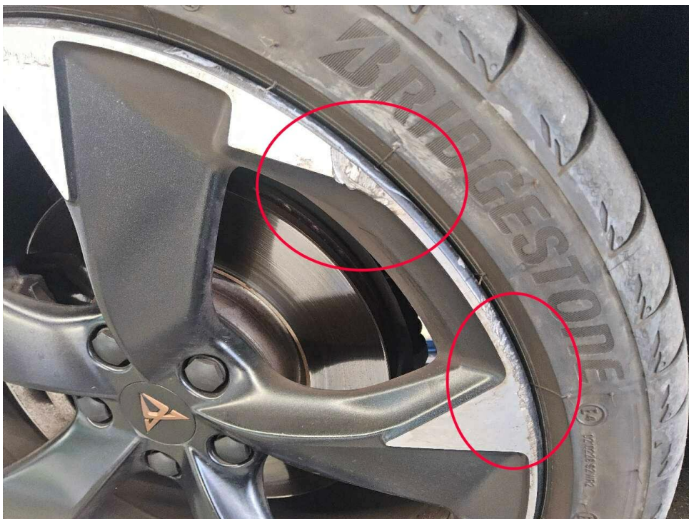
Bild 28 : LM Felge vorne links, glanzgedreht, verschrammt
