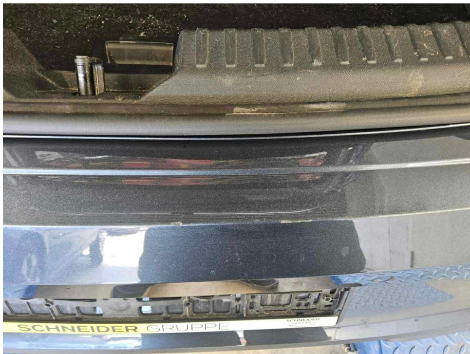
Bild 16 : Stoßfänger hinten Lackierung, verschrammt, smart repair
