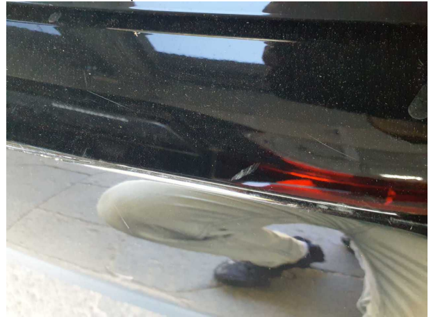
Beschädigung #4: Stossfänger hinten: Stossfänger hinten - Kratzer - Smart Repair
