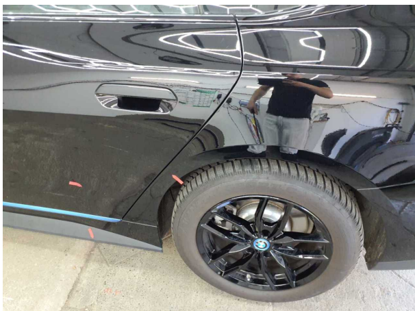
Beschädigung #3: Seitenwand links: Seitenwand - Delle(n) - Smart Repair
