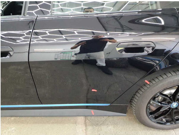
Beschädigung #6: Tür hinten links: Tür - Kratzer - lackieren
