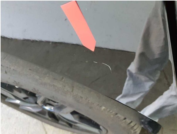
Beschädigung #8: Seitenwand rechts: Seitenwand - Kratzer - lackieren
