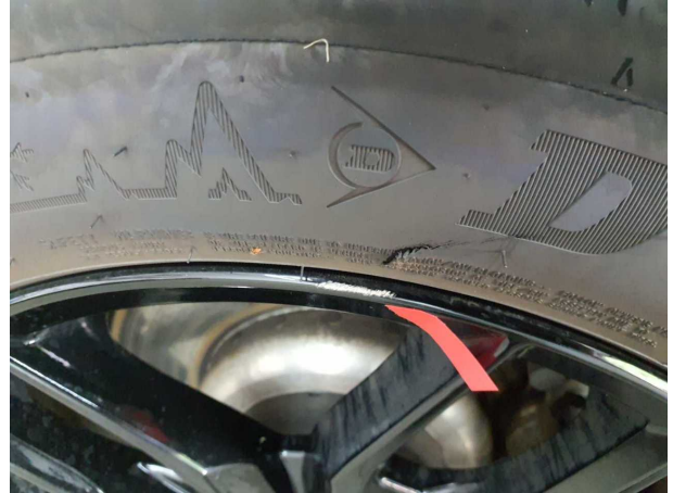
Beschädigung #1: Rad/Reifen: Leichtmetallfelge vorn links - Kratzer
