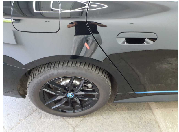
Beschädigung #8: Seitenwand rechts: Seitenwand - Kratzer - lackieren
