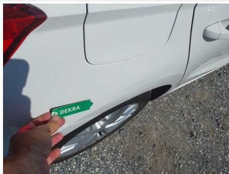
Aleta / Trasero Derecho / Abolladura
