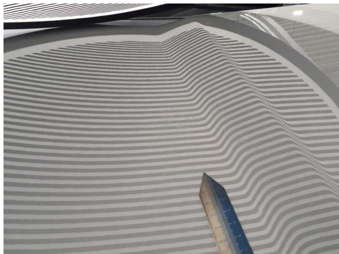
Damage 7: Bonnet: Bonnet (Anätzung) - Paint defect - Paint
