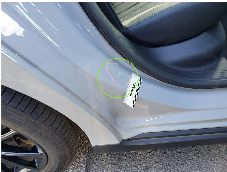
Bild 10 : Türeinstieg vorn rechts, verkratzt
