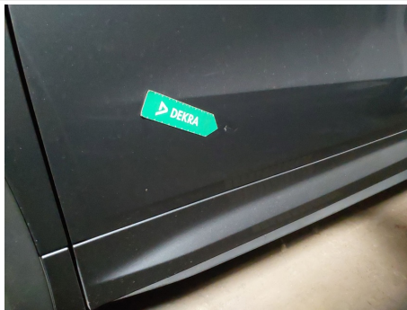
Puerta / Delantero Izquierdo / Abolladura
