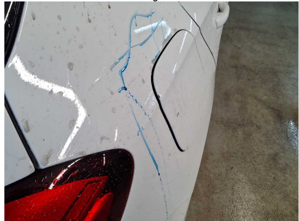
Beschädigung #2: Kraftstoffanlage: Tankdeckel - Fehlstellung... de-/montieren
