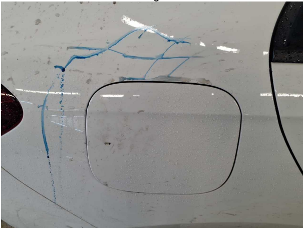
Beschädigung #2: Kraftstoffanlage: Tankdeckel - Fehlstellung - de-/montieren
