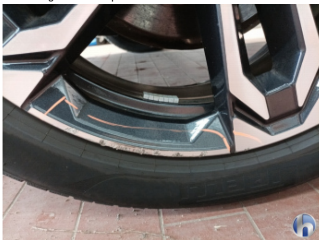
2. Felge Hinten - Rechts Beschädigt - Smart Repair
