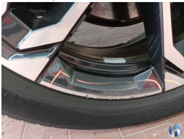
2. Felge Hinten - Rechts Beschädigt - Smart Repair
