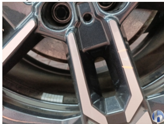
2. Felge Hinten - Rechts Beschädigt - Smart Repair
