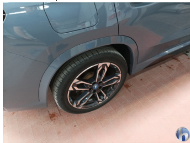
2. Felge Hinten - Rechts Beschädigt - Smart Repair
