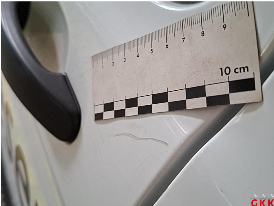
Bild 38 Schiebetür rechts, beschädigt, instand setzen - lackieren
