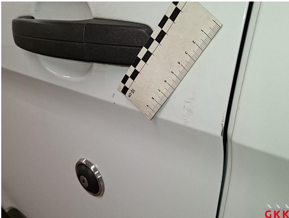
Bild 30 Tür vorne links, verkratzt, lackieren
