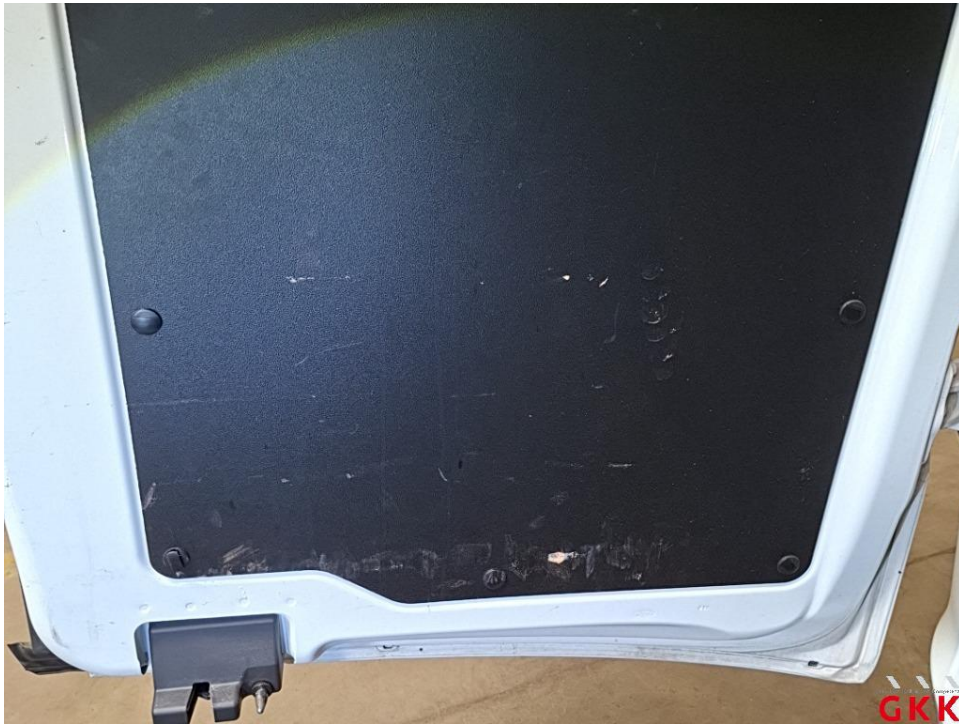
Bild 17 Hecktür links, Innenverkleidung, beschädigt, ersetzen
