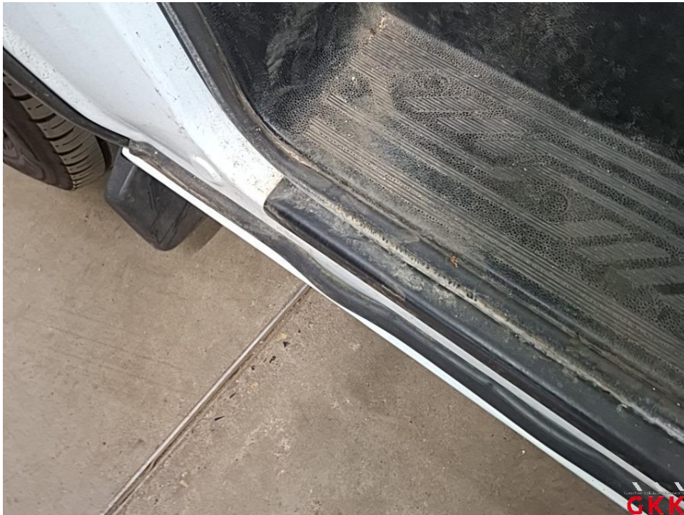
Bild 27 Tür vorne links, Dichtung -Einstieg-, beschädigt, ersetzen
