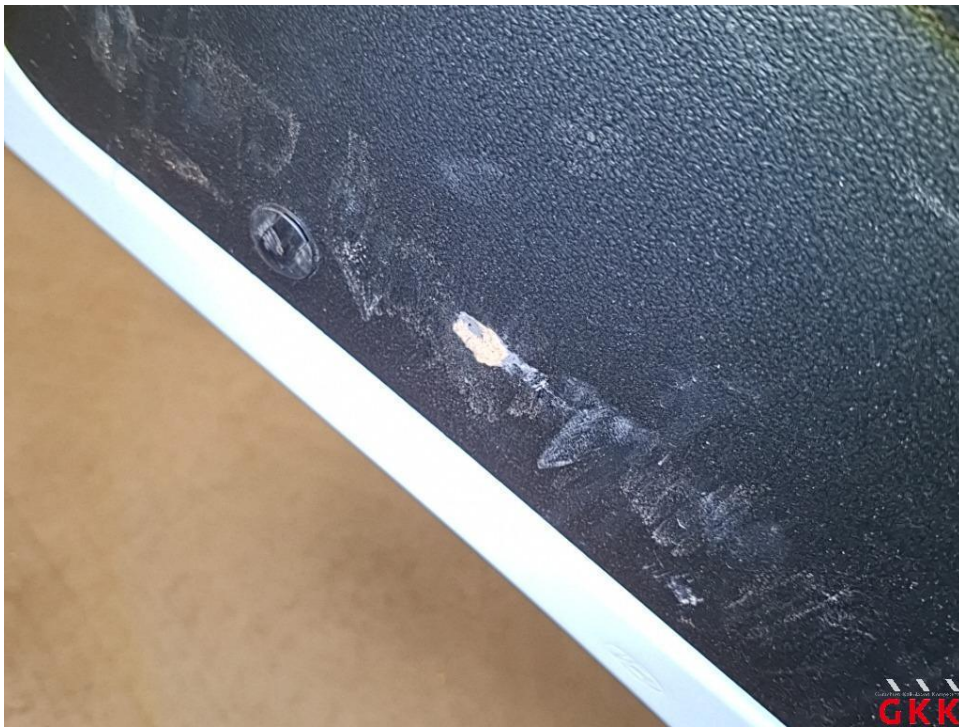
Bild 18 Hecktür links, Innenverkleidung, beschädigt, ersetzen
