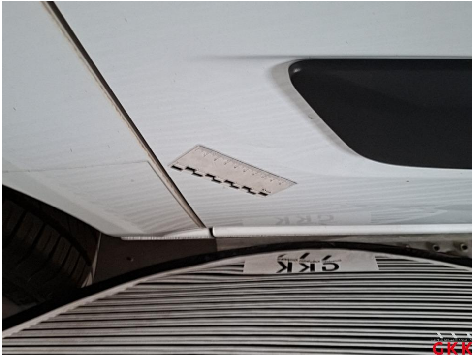
Bild 37 Schiebetür rechts, beschädigt, instand setzen - lackieren
