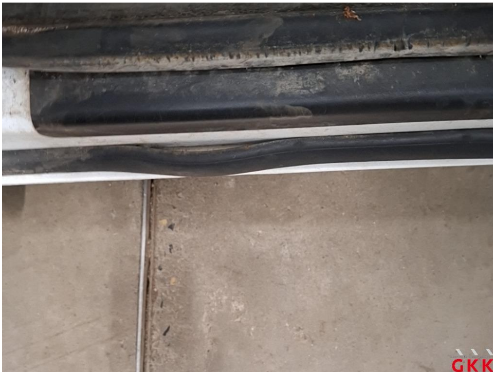
Bild 28 Tür vorne links, Dichtung -Einstieg-, beschädigt, ersetzen
