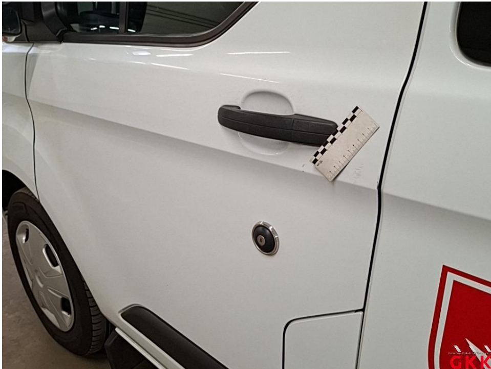
Bild 29 Tür vorne links, verkratzt, lackieren
