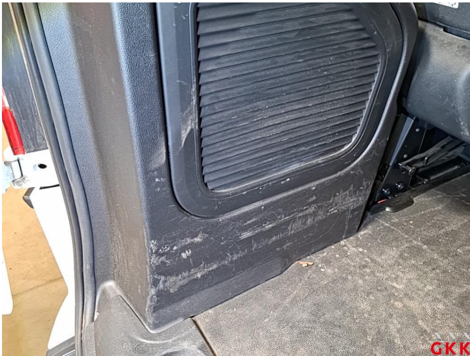
Bild 16 Fahrzeug, innen, verkratzt und verschmutzt, aufbereiten
