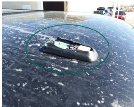
Embase d'antenne / - / Cassé
