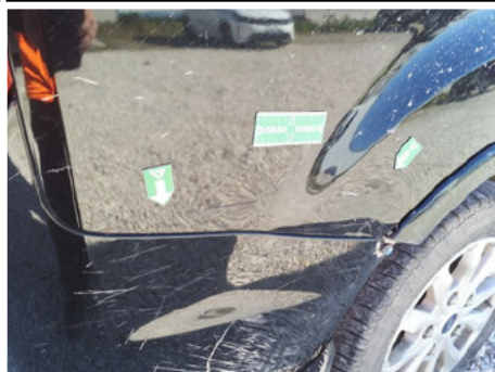
Panneau latéral / Arrière Droit / Enfoncement
