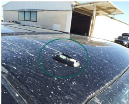
Embase d'antenne / - / Cassé
