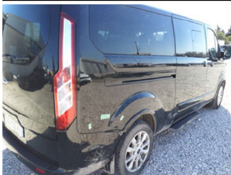
Panneau latéral / Arrière Droit / Enfoncement
