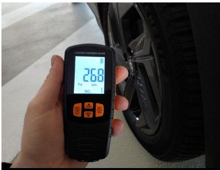
Kotflügel / Vorne Rechts / Schlecht Repariert
