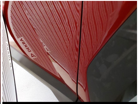
Tür / Vorne Rechts / Schlecht Repariert
