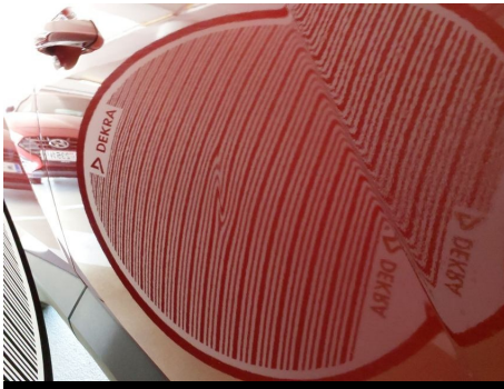
Tür / Vorne Rechts / Schlecht Repariert
