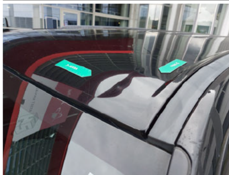
Dach / Vorne / Delle
