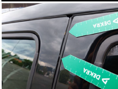
Tür / Vorne Links / Delle
