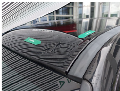
Dach / Vorne / Delle
