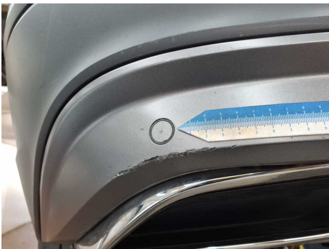
Damage 20: Rear bumper: Spoiler (Mit Blende lose) - Scratched - Paint
