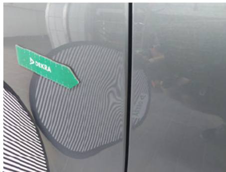
Tür / Hinten Rechts / Delle
