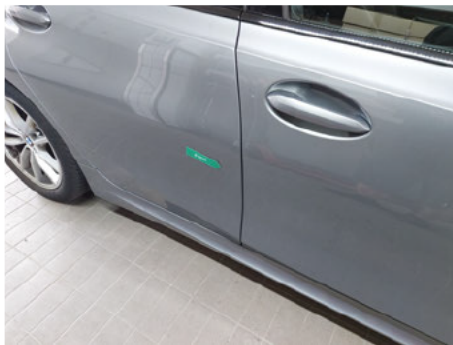
Tür / Hinten Rechts / Delle
