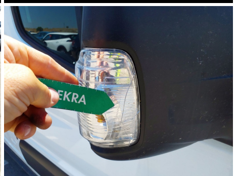
Piloto del intermitente / Derecha / Roto
