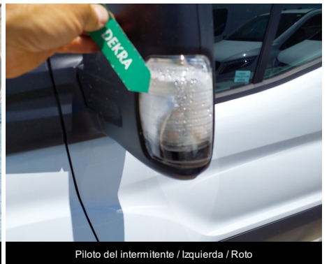
Piloto del intermitente / Izquierda / Roto
