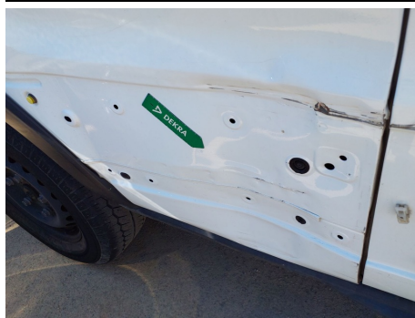
Moldura de aleta / Trasero Derecho / Faltante
