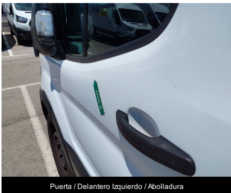
Puerta / Delantero Izquierdo / Abolladura
