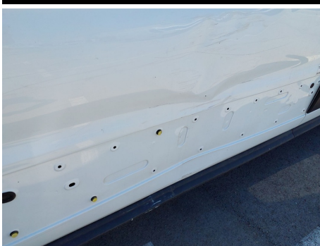
Door moulding trim / Trasero Derecho / Faltante
