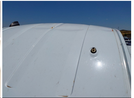
Techo / Delantero / Abolladura
