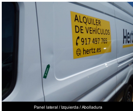
Panel lateral / Izquierda / Abolladura
