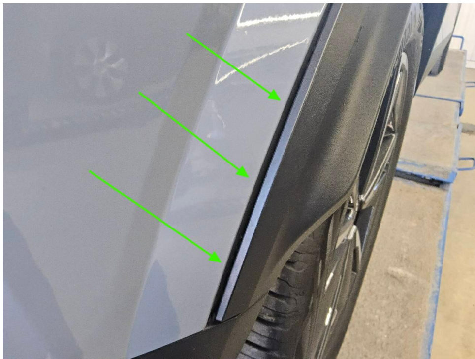
Bild 19 : Stoßfänger hinten, Radlaufblende Halterung gebrochen
