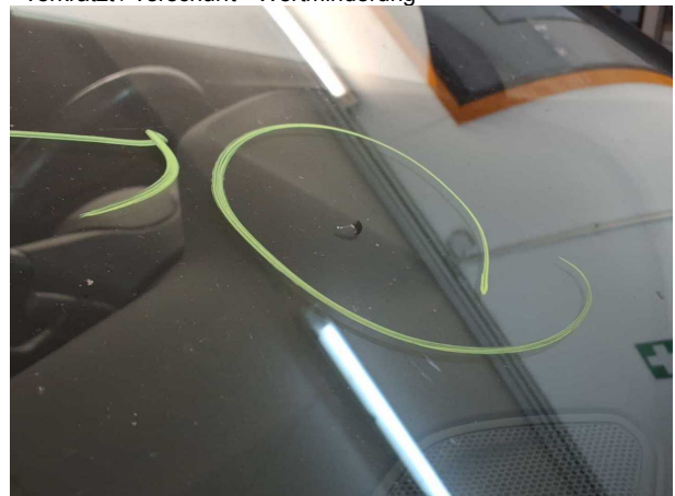
Beschädigung #4: Verglasung: Frontscheibe - Steinschlag - erneuern
