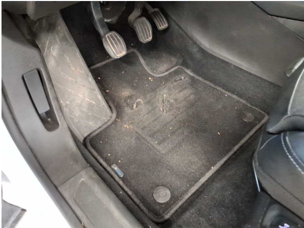
Beschädigung #2: Verkleidungen/Abdeckungen: Fußmatten - beschädigt - erneuern
