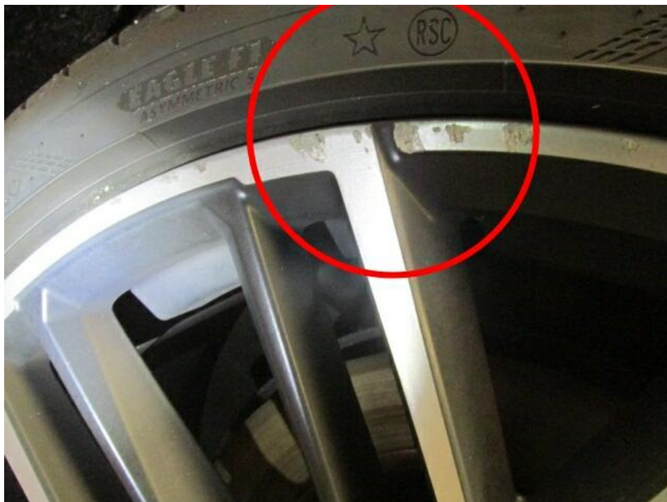
Bild 18 : Felge hinten rechts verschrammt ( glanzgedreht).
