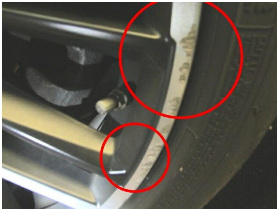
Bild 17 : Felge hinten rechts verschrammt ( glanzgedreht).
