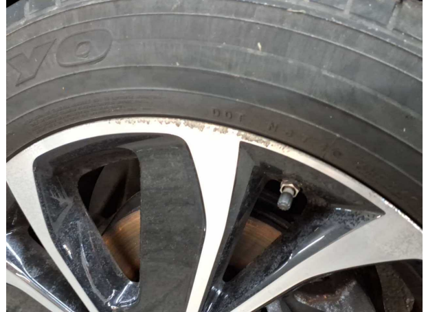
Beschädigung #1: Rad/Reifen: Leichtmetallfelge vorn rechts - Kratzer - Wertminderung
