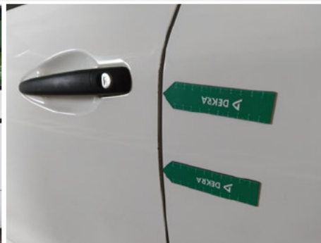
Tür / Vorne Links / Abgewetzt
