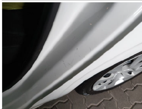
Türeinstieg / Hinten Links / Kratzer
