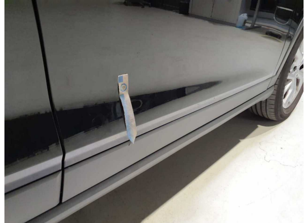
Beschädigung #1: Tür vorn rechts: Zierleiste unten - verkratzt / verschürft - erneuern
