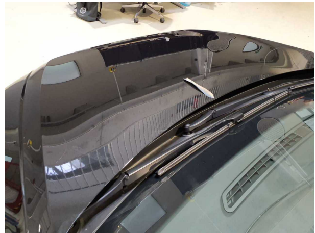
Beschädigung #4: Motorhaube: Motorhaube - verkratzt / verschürft - lackieren
