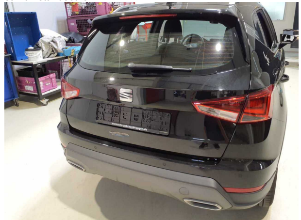
Beschädigung #3: Heckklappe/-tür: Heckklappe - verkratzt / verschürft - Smart Repair
