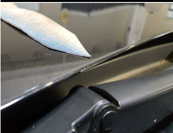
Beschädigung #4: Motorhaube: Motorhaube - verkratzt / versch... - lackieren
