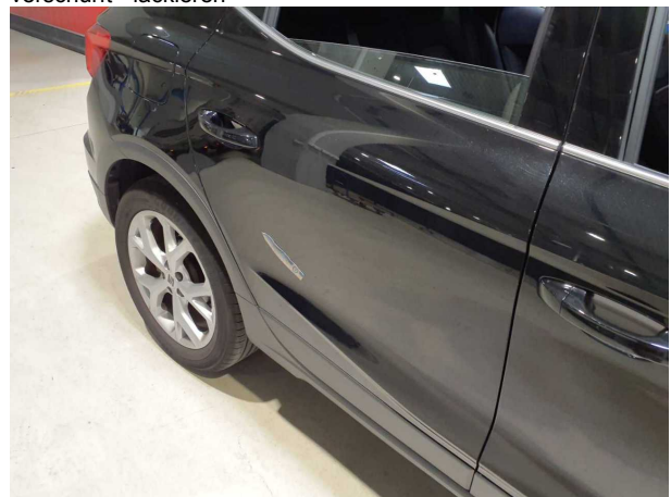
Beschädigung #5: Tür hinten rechts: Tür - Delle(n) - sanft instandsetzen
