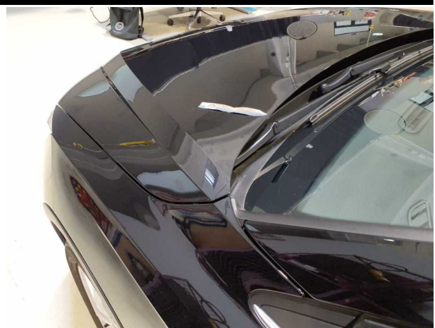
Beschädigung #4: Motorhaube: Motorhaube - verkratzt / verschürft - lackieren
