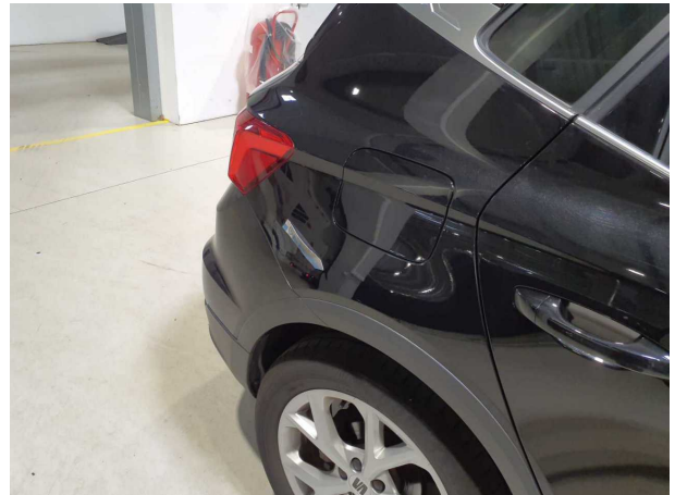
Beschädigung #2: Seitenwand rechts: Seitenwand - Delle(n) - sanft instandsetzen
