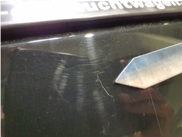
Beschädigung #3: Heckklappe/-tür: Heckklappe - verkratzt / verschürft - Smart Repair
