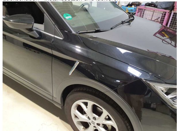
Beschädigung #8: Kotflügel rechts: Kotflügel rechts - Delle / Lackschaden - instandsetzen und lackieren
