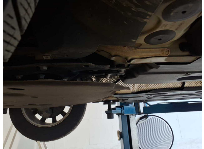
Damage 1: Body: Underbody panelling (Schrauben fehlen) - Loose - Replace
