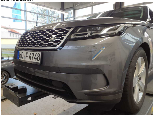
Beschädigung #4: Stossfänger vorn: Stossfänger vorn (Inkl Leist... - verkratzt / verschürft - instandsetzen und lackieren
