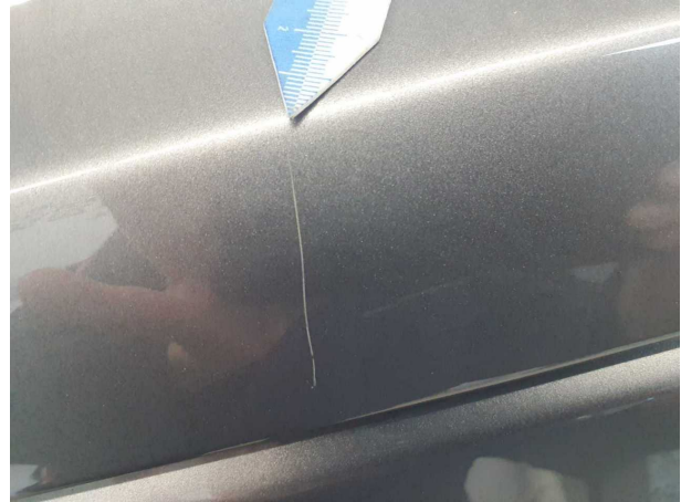
Beschädigung #5: Motorhaube: Motorhaube - Kratzer - instandsetzen und lackieren
