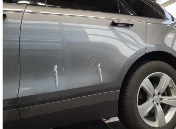
Beschädigung #3: Tür hinten links: Tür - Delle(n) - instandsetzen und lackieren
