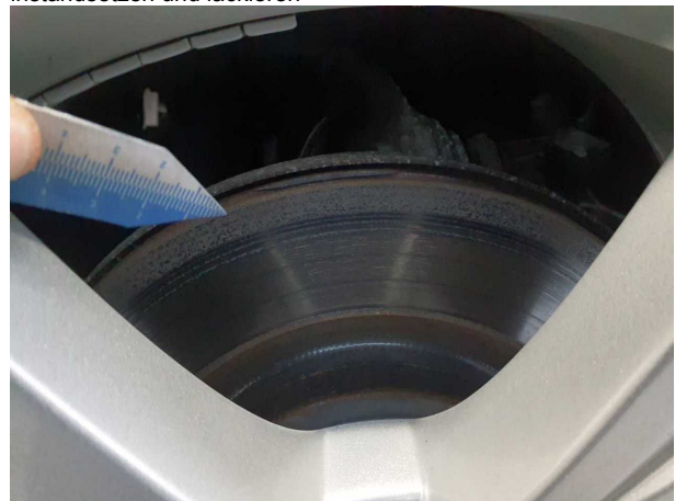
Beschädigung #6: Bremsanlage: Bremsscheiben und Beläge hinten - Korrosion - erneuern
