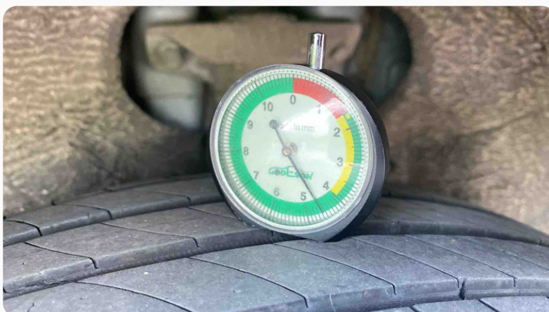
Photo mesure usure pneu arrière gauche
