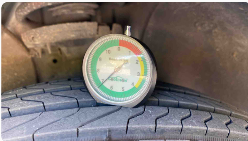
Photo mesure usure pneu avant droit
