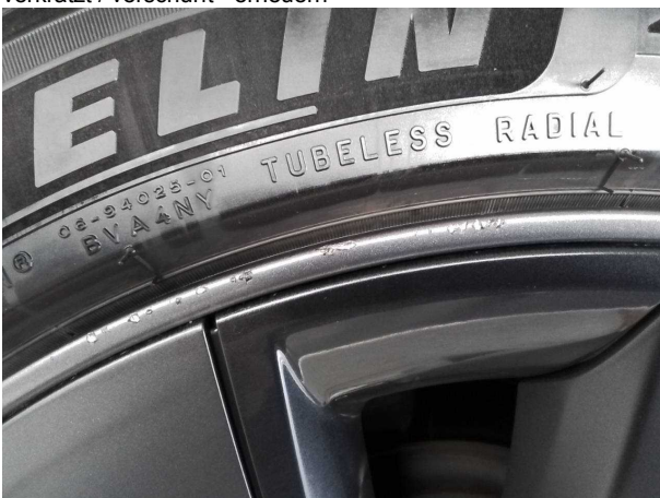
Beschädigung #3: Rad/Reifen: Leichtmetallfelge hinten links - verkratzt / verschürft - erneuern
