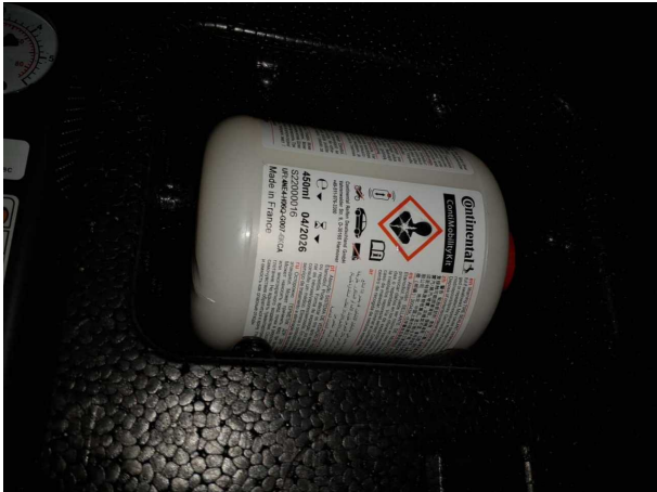
Beschädigung #1: Ausrüstung: Tirefit Füllmittel - fällig - erneuern
