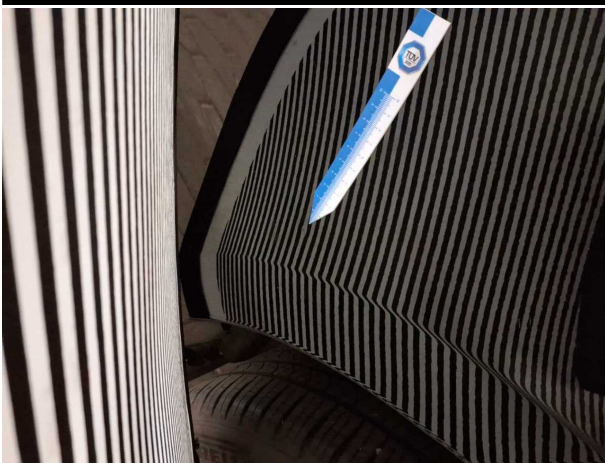
Beschädigung #3: Tür hinten links: Tür (+ verkratzt) - Delle / Lackschaden - instandsetzen und lackieren
