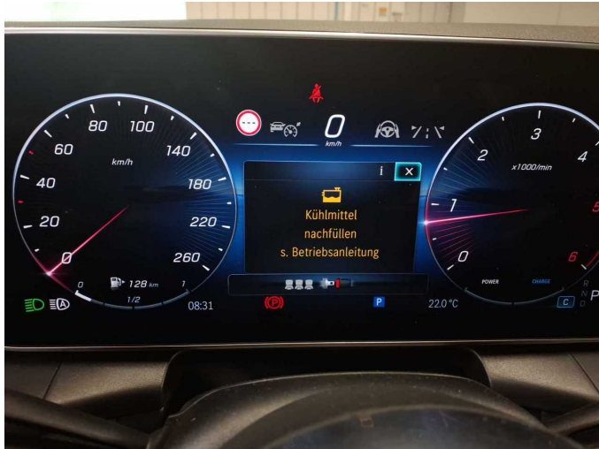
Damage 3: Engine cooling: Coolant (Füllstand niedrig; Mehrkosten möglich) - Perform diagnosis
