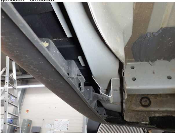
Beschädigung #7: Heckbereich: Heckblech - verformt - Smart Repair
