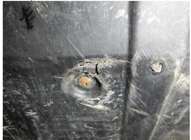
Beschädigung #6: Motor: Motorverkleidung unten - gebrochen / gerissen - erneuern
