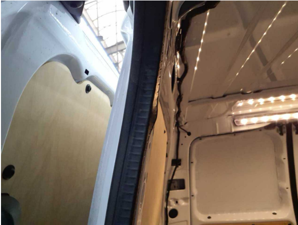
Beschädigung #3: Schiebetür rechts: Türdichtung - verformt - erneuern
