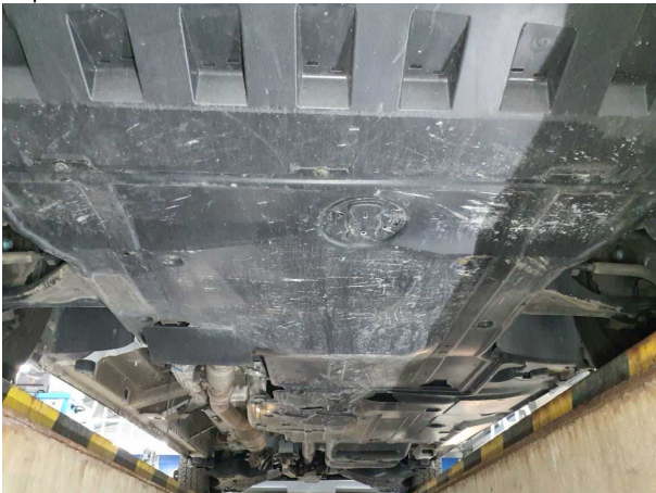
Beschädigung #6: Motor: Motorverkleidung unten - gebrochen / gerissen - erneuern
