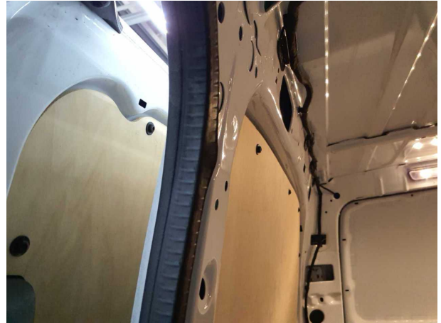
Beschädigung #3: Schiebetür rechts: Türdichtung - verformt - erneuern
