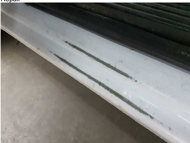
Beschädigung #9: Schweller links: Einstieg - Lackmangel - lackieren
