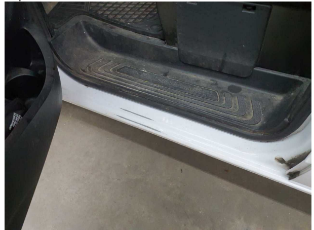
Beschädigung #9: Schweller links: Einstieg - Lackmangel - lackieren
