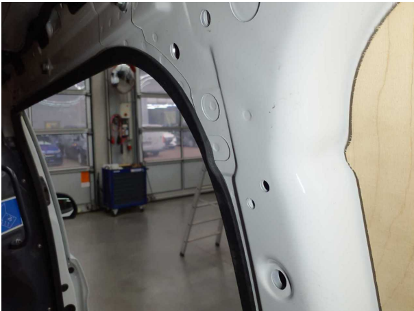
Beschädigung #3: Schiebetür rechts: Türdichtung - verformt - erneuern
