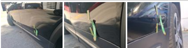
Door trim FL, Scratch(es), Replace
