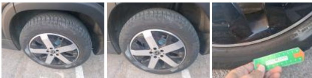
Alloy rim RL bitone/polychrome, Scratch(es), Repair/replace (lump sum)
