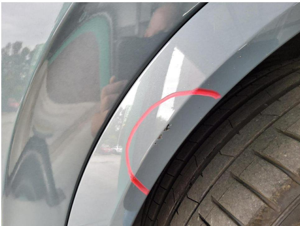
Bild 18 : Kotflügel vorne links Zierleiste, zerkratzt, smart repair
