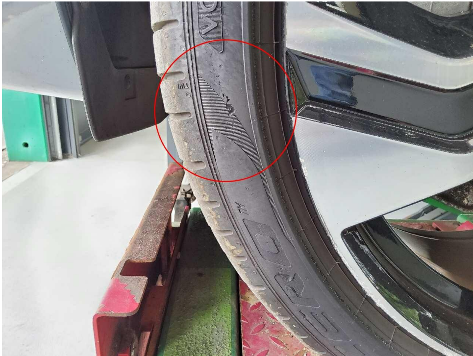
Bild 49 : Flankenschaden Reifen vorne links
