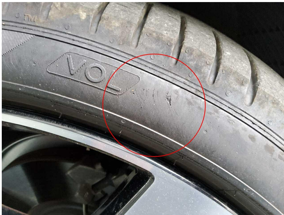
Bild 52 : Flankenschaden Reifen vorne rechts
