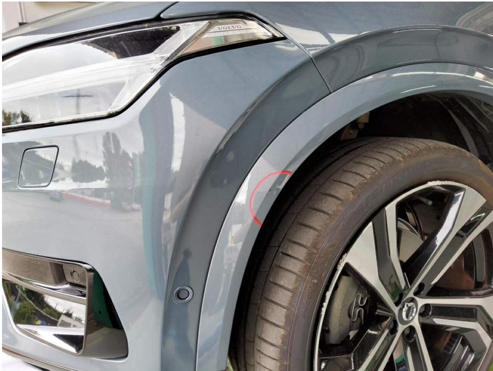
Bild 17 : Kotflügel vorne links Zierleiste, zerkratzt, smart repair
