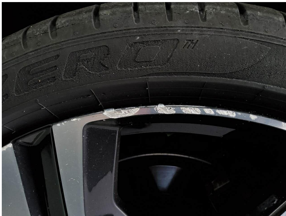
Bild 39 : Glanzgedrehte Alufelge H.R verschrammt
