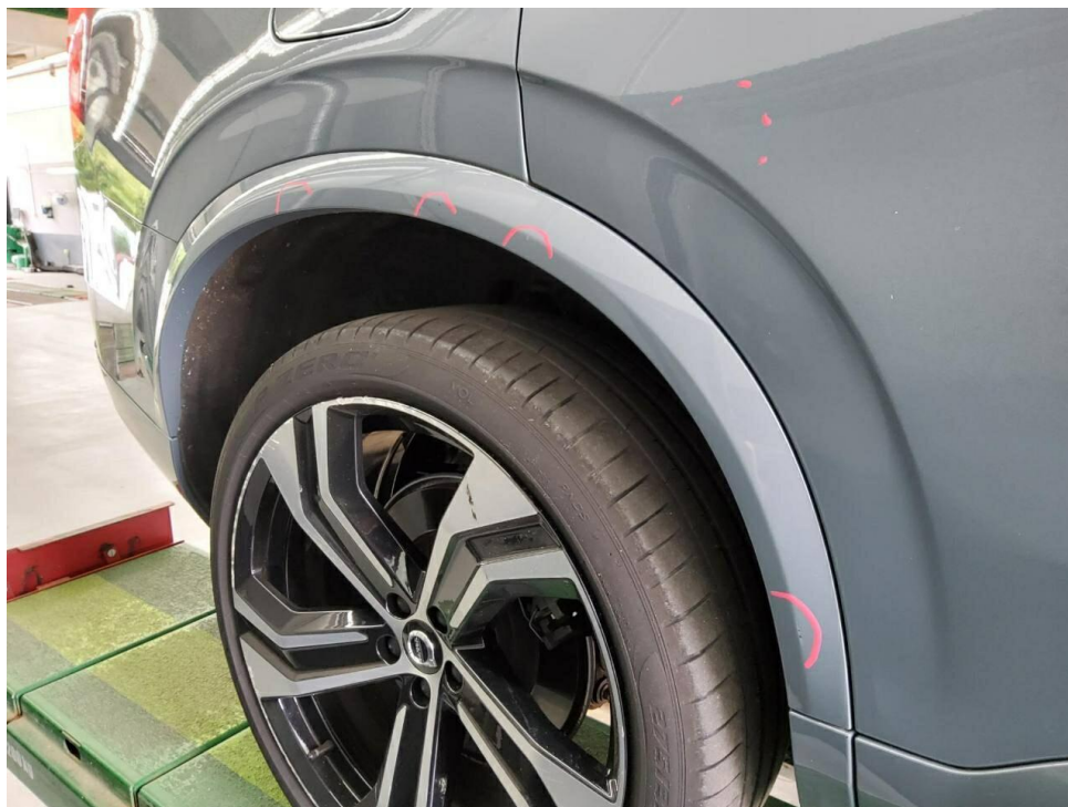
Bild 13 : Seitenteil hinten rechts Zierleiste, zerkratzt, lackieren
