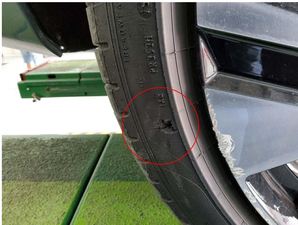
Bild 51 : Flankenschaden Reifen hinten rechts
