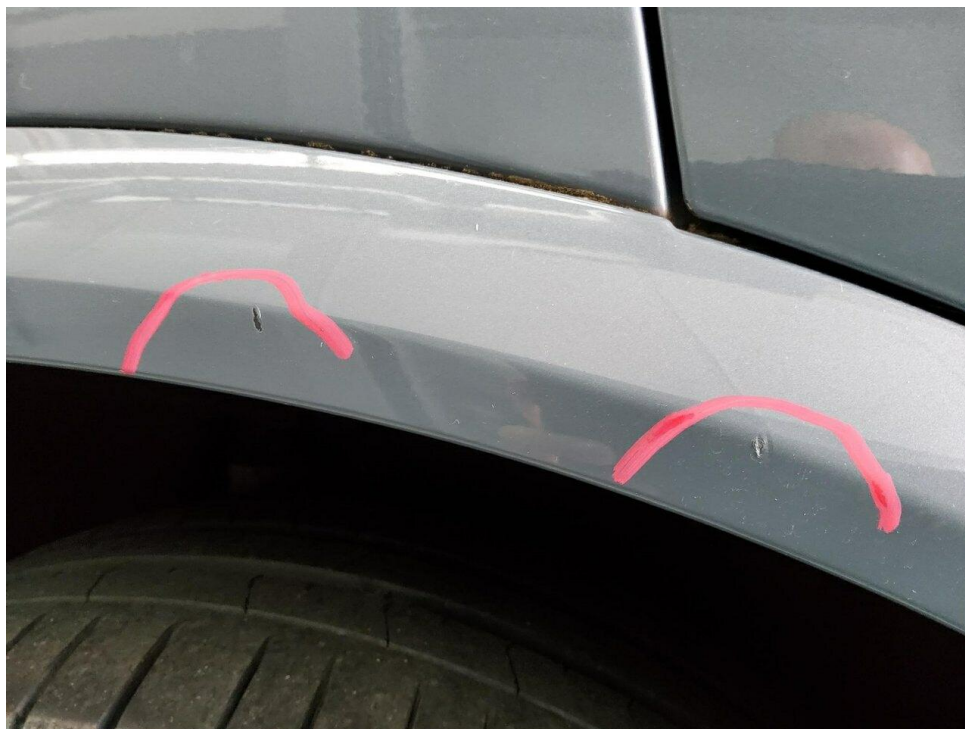
Bild 15 : Seitenteil hinten rechts Zierleiste, zerkratzt, lackieren
