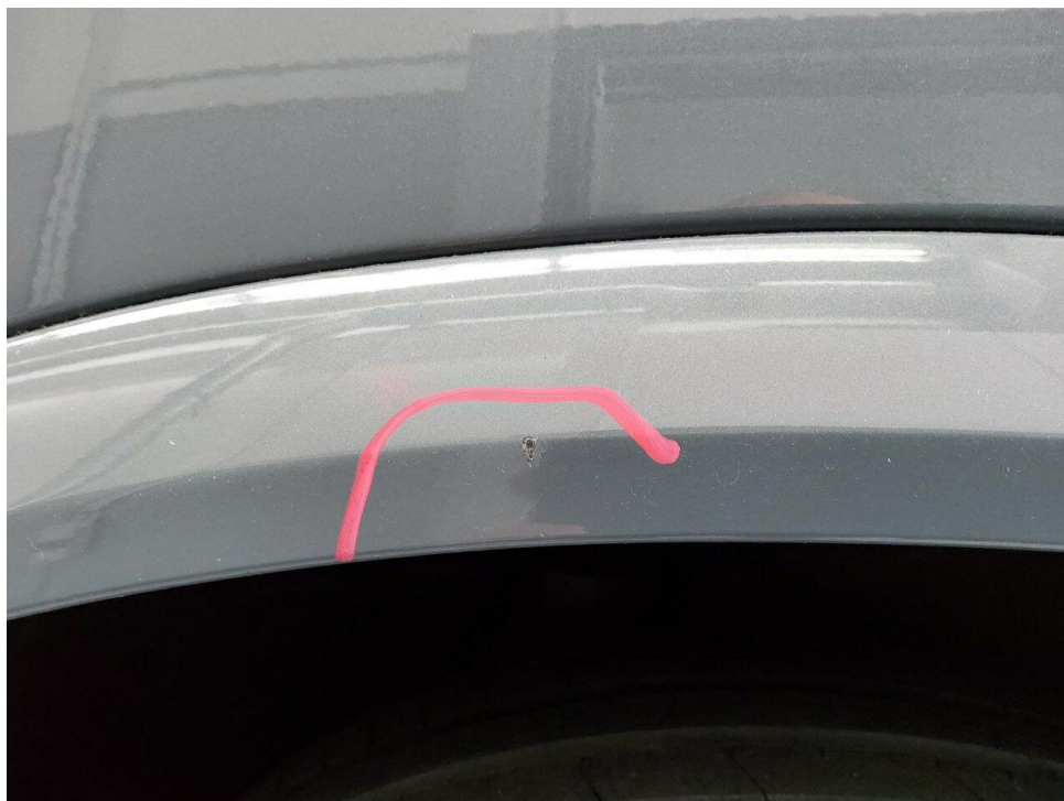
Bild 14 : Seitenteil hinten rechts Zierleiste, zerkratzt, lackieren
