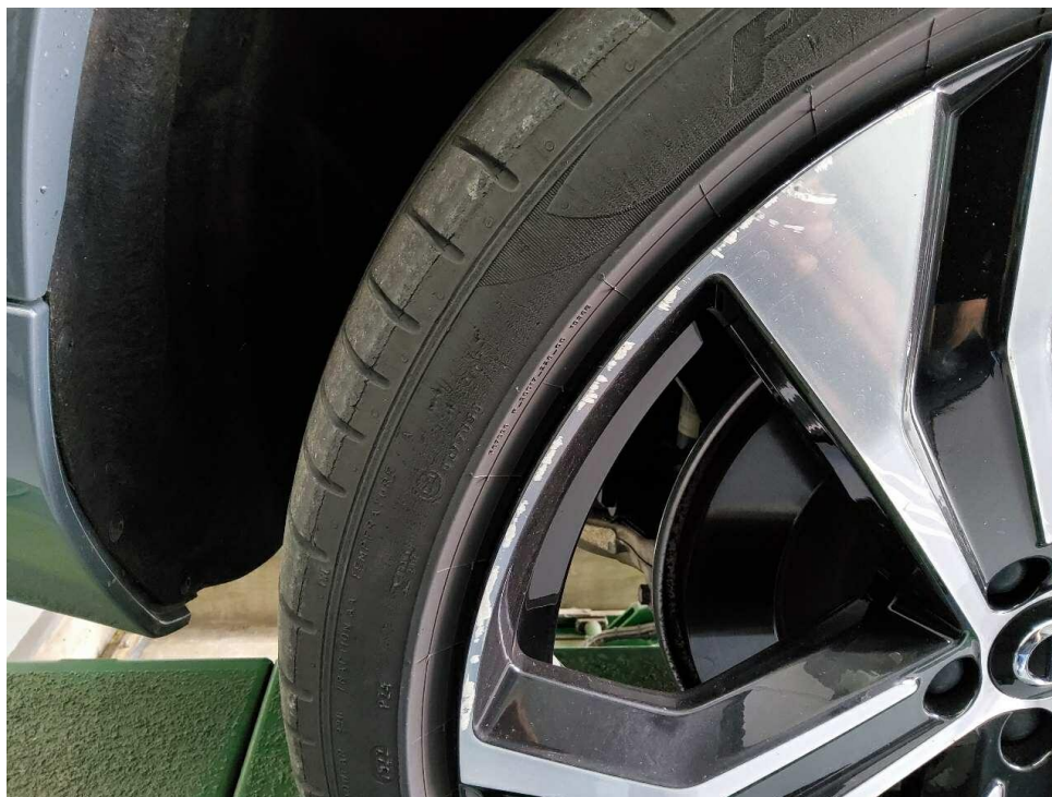
Bild 40 : Glanzgedrehte Alufelge H.R verschrammt
