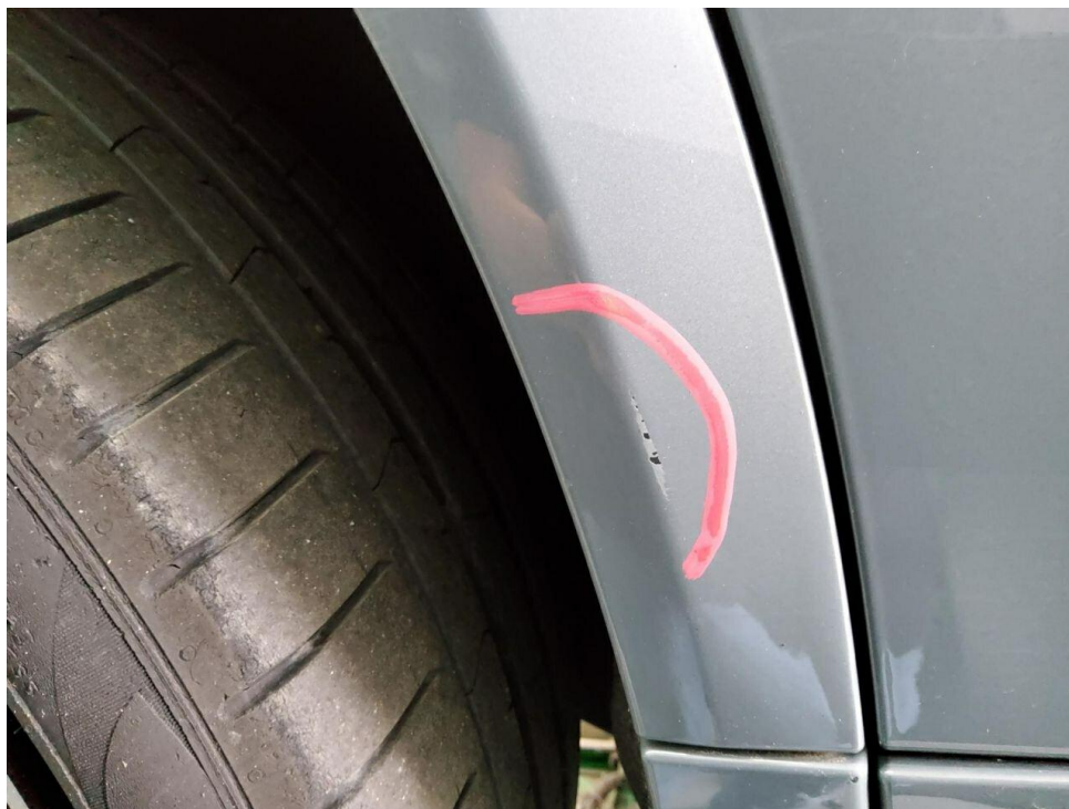
Bild 16 : Seitenteil hinten rechts Zierleiste, zerkratzt, lackieren
